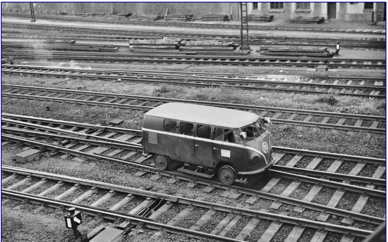
Der Bahnmeister von Minden geht am 18. Mai 1961 auf Inspektionsfahrt: Immerhin bis zu 70 km/h war der auf dem VW Transporter basierende Klv 20, hier das Fahrzeug mit der Nummer 5021. Gebremst wurde es über eine Fußpedalbremse, die hydraulisch auf alle vier Räder wirkte. Foto: Joachim Claus, Eisenbahnstiftung
