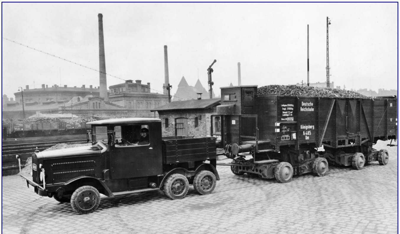
Am 27. April 1933 führt die Reichsbahn in Berlin-Anhalter Gbf Testfahrten mit dem ersten Culemeyer-Gespann durch. Zugmaschine ist eine Kaelble Z 6 R mit 100 PS Leistung. Nur drei Zugmaschinen dieses Typs wurden an die Reichsbahn geliefert. Foto: RVM, Archiv Eisenbahnstiftung
