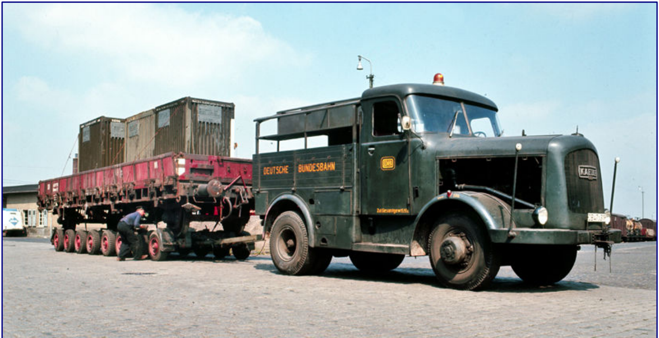
Ein Culemeyer-Transport mit der Kaelble-Zugmaschine KV 631 ZR 58 (DB 47-311) steht 1964 vor dem Frankfurter Hauptgüterbahnhof, wo sich heute das Messegelände an der Osloer Straße befindet. Der Fahrer prüft die korrekte Position des Rmms 33 auf dem angehängten Straßenroller des Typs LR 40, bevor es losgehen kann. Foto: Reinhold Palm, Archiv Eisenbahnstiftung
