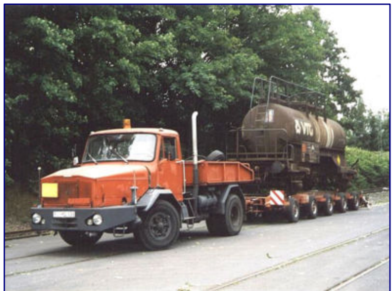
Das Kunststoffwerk Hagedorn in Lingen (Ems) erhielt Kesselwagen im Straßen-rollerverkehr. Die im Bild am 11. September 2001 fotografierte Straßenzugmaschine Faun F 610/36 Z (ehemals DB 47-682) wurde in eigener Verantwortung noch bis 2005 eingesetzt. Foto: Stefan Kunzmann (Public Domain)
