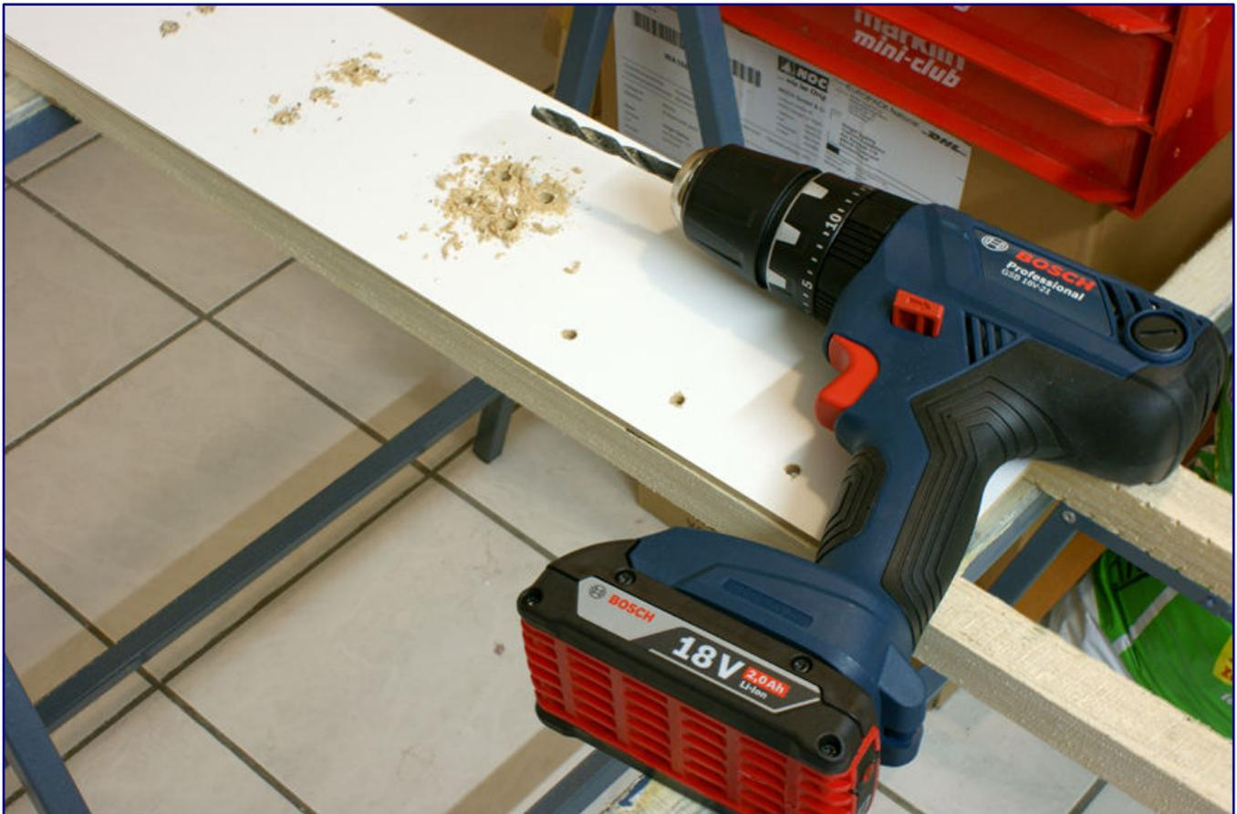
Die Durchmesser der Bohrungen für Schalter, Taster und Buchsen richten sich nach der Schaftmaßen der Einbauteile, die entweder vom Hersteller angegeben und selbst gemessen werden.
