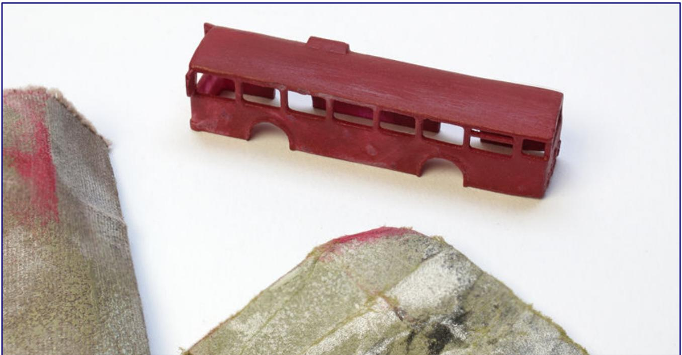
**Nach dem ersten Farbauftrag treten noch einige Unebenheiten und Fehler zu Tage, die vor dem nächsten Lackiervorgang noch verschliffen werden müssen.**
