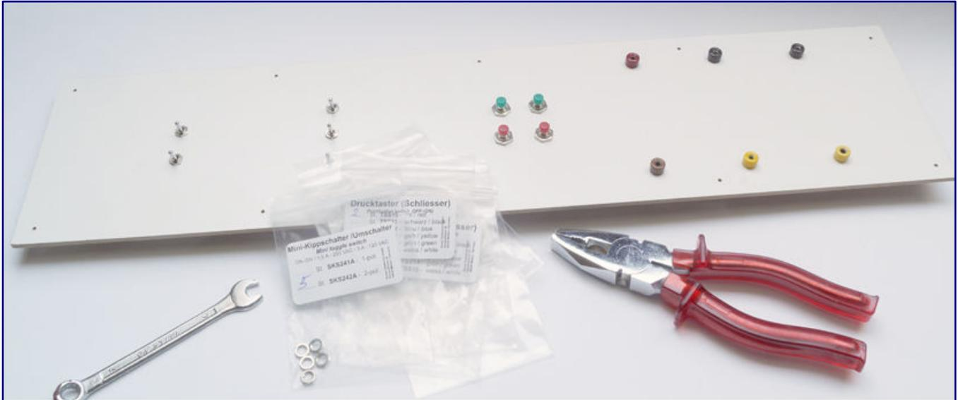
Schalter, Taster und Buchsen werden in die Blende aus MDF eingesteckt und festgeschraubt. Zu erkennen ist im Bild auch, dass die zehn Schraublöcher zum Befestigen an der Rückwand bereits vorgebohrt wurden. Jetzt fehlen nur noch die Beschriftungen aus dem Etikettendrucker, mit dem alle Bedienelemente und die Buchsen gekennzeichnet werden.
