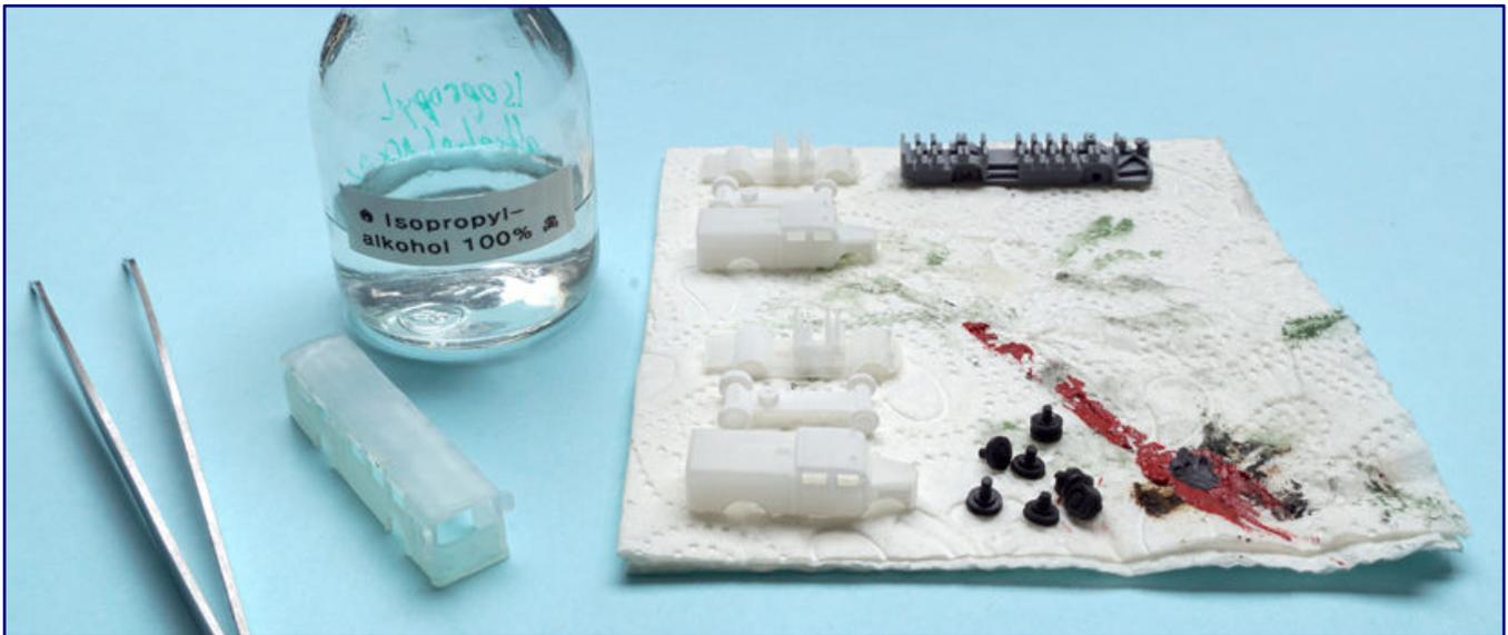
Gut beraten ist wohl jeder, der seine 3D-Druckmodelle vor der Farbgebung für fünf Minuten in reinem Isopropylalkohol badet. Der Einfachalkohol löst nicht nur anhaftende Fette, sondern auch Reste von Stützmaterial oder nicht ausgehärtetem Resin. Unser Bus unterzieht sich der Prozedur zusammen mit anderen Fahrzeugen, die parallel in Arbeit sind.
