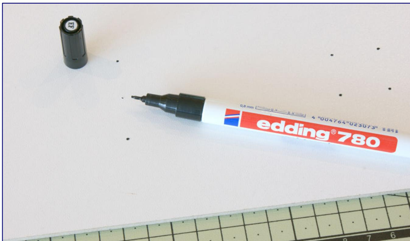
Das Übertragen der Bohrpunkte geht einfach und schnell von der Hand: Papierschablone auf die MDF-Platte auflegen, ausrichten und mit dem Vorstechwerkzeug die Mittelpunkte übertragen (Bild oben). Anschließend heben wir diese noch mit einem Edding 780 hervor, um diese unmissverständlich sichtbar zu machen (Bild unten).
