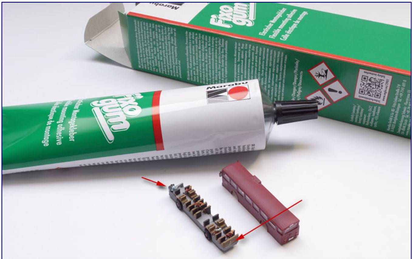
Fahrwerk und Aufbau verbinden wir mit einer wiederlösbaren Variante: Wir greifen zu Fixogum von Marabu. Sollte der Bus doch noch mal auf das Z-Car-System umgebaut werden oder mal eine Figur im Inneren umfallen, bleibt ein Zugriff weiter möglich.
