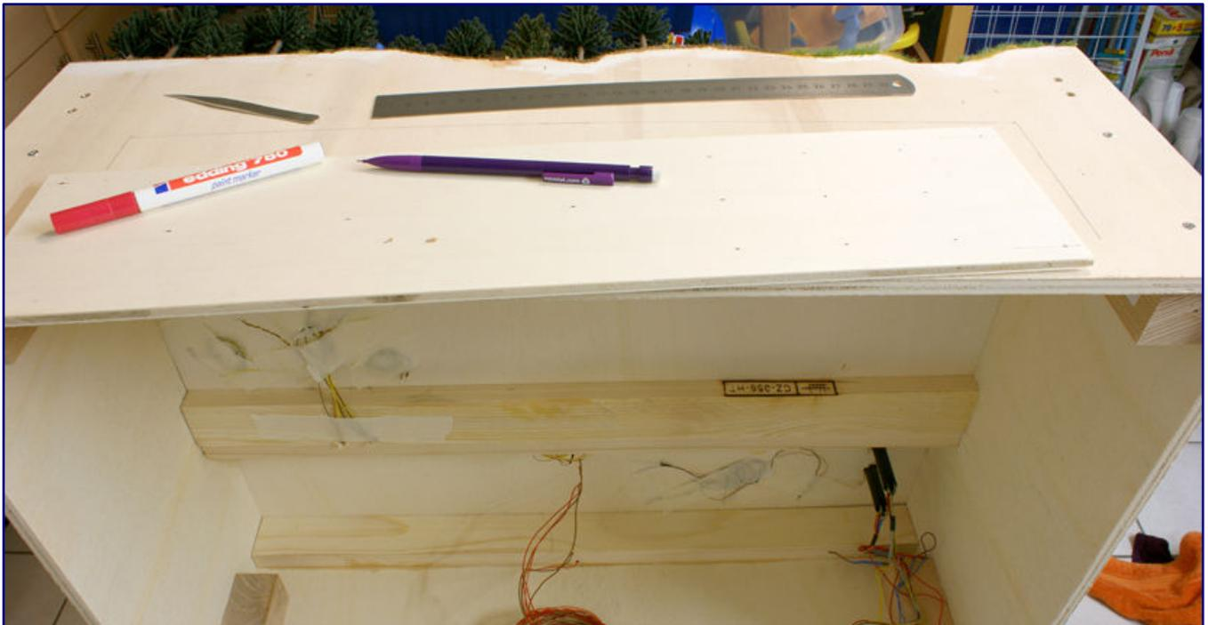
Damit auch die Kippschalter vor Beschädigungen geschützt sind, müssen sie tiefer montiert werden. Zwischenbauen werden wir deshalb noch eine 6-mm-Sperrholzplatte. Auf diese übertragen wir die Mittelpunkte der erforderlichen Öffnungen mittels eines Stechwerkzeugs aus einer defekten Pinzette und einem (roten) Edding-Stift mit feiner Spitze.
