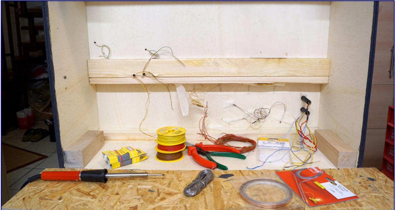
Die Phase des „Strippenziehens“ beginnt: Die Litzen in den von Märklin definierten Kennfarben (siehe Informationskästchen) und Kabelhalter zum Ordnen und Fixieren stammen von Brawa. Als Lötverteiler dient Kupferklebeband von Busch, das Ströme bis zu 2 A leiten kann.
