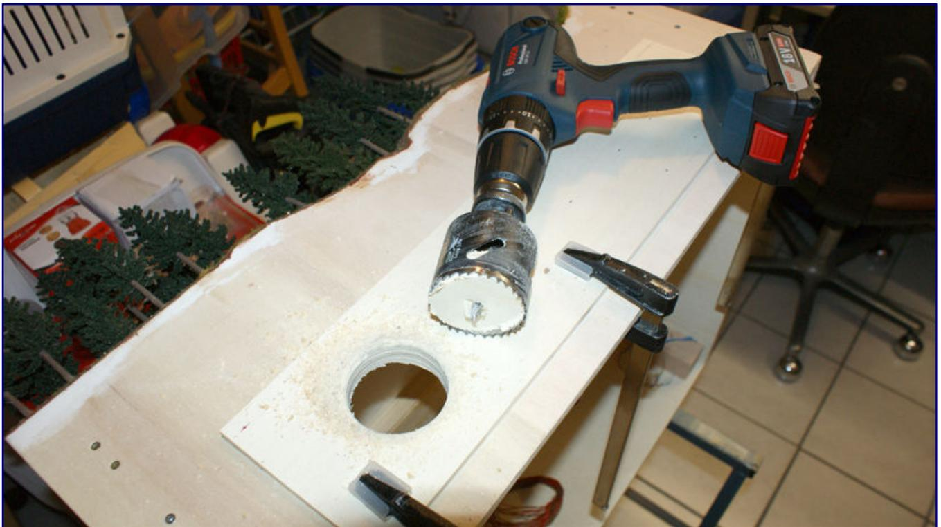
Die später „unterflur“ montierte Platte wird zunächst aufgelegt, ausgerichtet und mit Spannzwingen fixiert. Dann rückt der Akkubohrschrauber an, zunächst mit Lochsägeaufsatz, anschließend mit Forstner-Bohrern in zwei verschiedenen Durchmessern.
