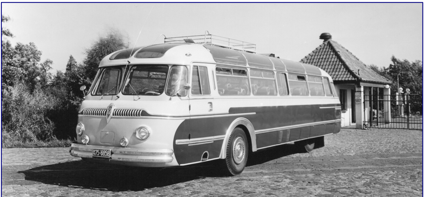
Auch als Reisebusversion wurde das Basismodell mit dem luftgekühlten KHD-Motor gebaut und hieß dann werksseitig BS 311. Dachrandverglasung und Dachgepäckträger waren damalige Merkmale einer gehobeneren Ausstattung. Foto: Werksaufnahme NWF, Archiv Bernd Coldewey
