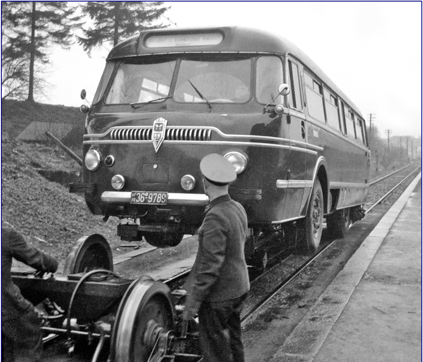
Als der Schienen-Straßenbus mit dem französischen Besatzungskennzeichen FR 36-9789 im April 1956 in Dierdorf (Westerwald) zur Weiterfahrt nach Altenkirchen aufgeleitet wird, führt er auch die Arbeit der beiden vorderen Hydraulikstempel des Serienfahrzeugs vor. Foto: Reinhard Todt, Eisenbahnstiftung
