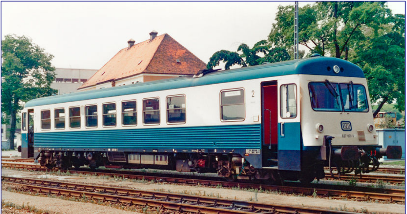
Diese Aufnahme vom 13. Juli 1985 in Kempten (Allgäu) zeigt den 627 001-1 der Deutschen Bundesbahn im Betriebszustand, den auch das geplante SMZ-Modell wiedergeben soll. Der Triebwagen wurde im Jahr zuvor auf reguläre Zug- und Stoßeinrichtungen umgebaut. Foto: Malte Werning.
