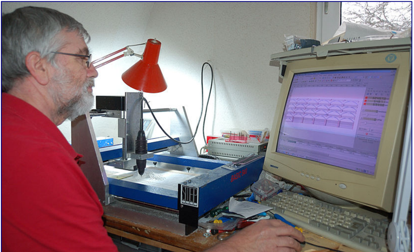
Auf die Vorbildrecherchen folgt das Zeichnen am Rechner, bevor die Fräse (Mitte) mit dem Herausarbeiten der Strukturen auf Polystyrolplatten beginnen kann. Foto: Rainer Tielke
