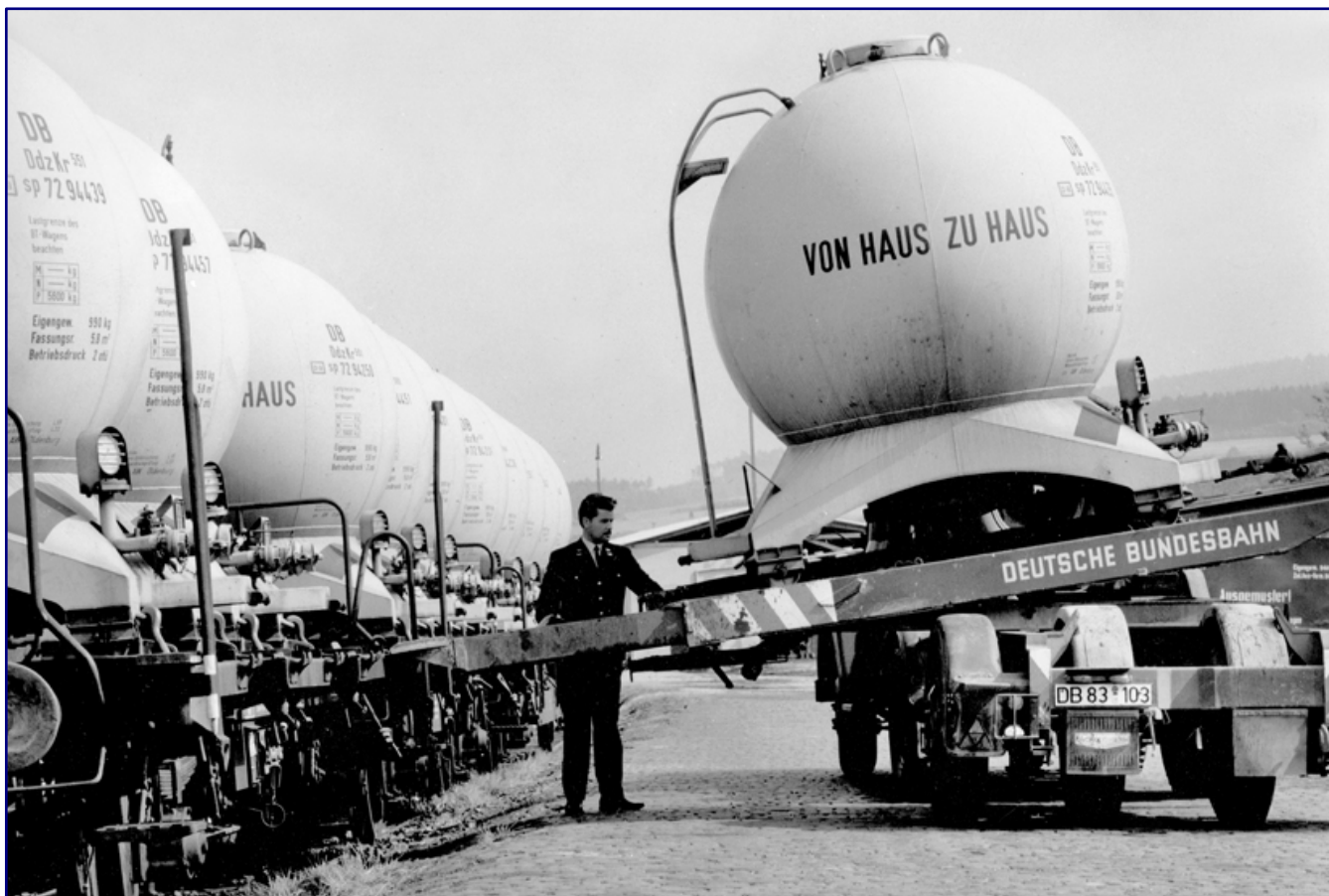
Die Zement-Behälter auf einem BTms 55 in Letmathe (März 1965; Bild oben) und die Kugelbehälter für Druckluftentladung Ddzkr 551 (1961; Bild unten) sind weitere Beispiele für die vielen Spezialbehälter. Fotos: Reinhard Todt, Eisenbahnstiftung (oben) / Helmut Först, Eisenbahnstiftung (unten)
