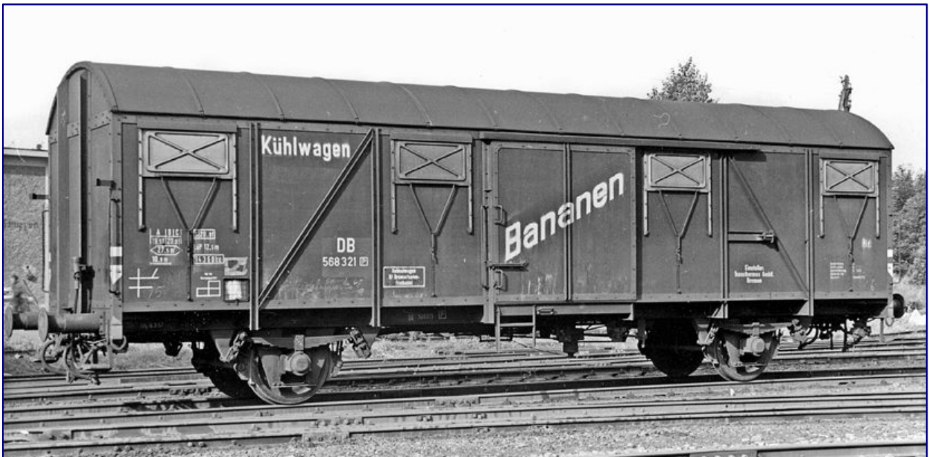
Die Wärmeschutzwagen Tnohs 59 für den Transport von Bananen wurden aus gedeckten Wagen der Gattung Gimhs 50 hergerichtet. Sie besaßen einen Aufbau mit Kunstharzholzplatten, wie er künftig Standard werden sollte. Als der Wagen mit der Betriebsnummer 568 321 [P] der Transthermos GmbH Bremen 1957 aufgenommen wurde, war er noch nahezu fabriken und zeigte kaum Betriebsspuren. Foto: Bustorff, Eisenbahnstiftung
