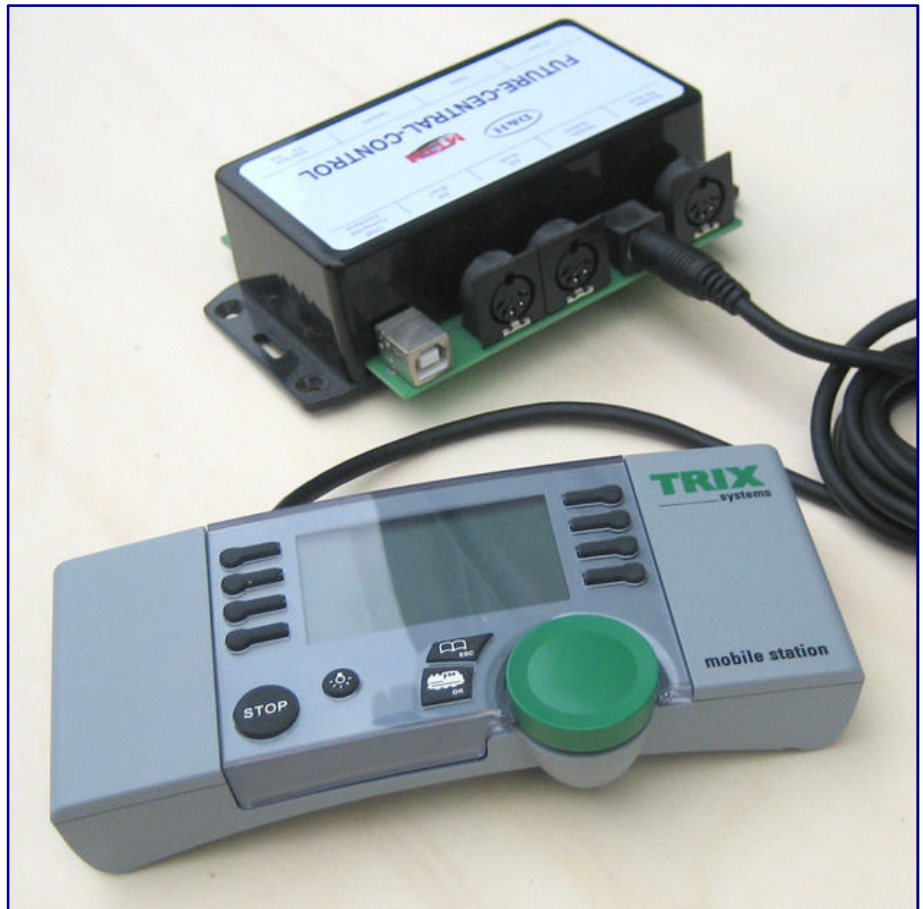
Hier ist eine Mobile Station 1 von Trix als Handregler an die FCC angeschlossen worden. Auf sich allein gestellt, arbeitet sie auch als kleine Zentrale, allerdings nur für den Zugetrieb.
