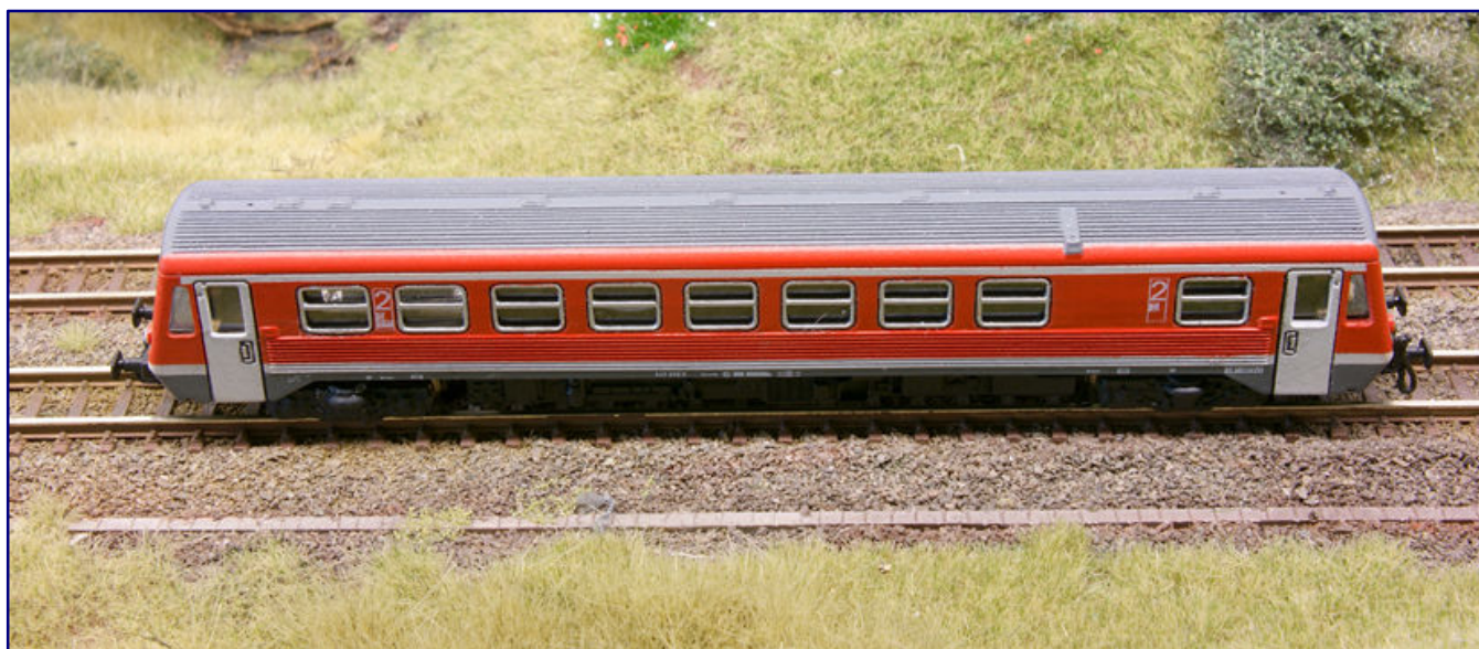
Auf dieser Aufnahme sind auch die Sicken im Dach gut zu sehen. Im vorderen rechten Bereich befindet sich an der Dachkante der Auspuff des Dieselmotors.
