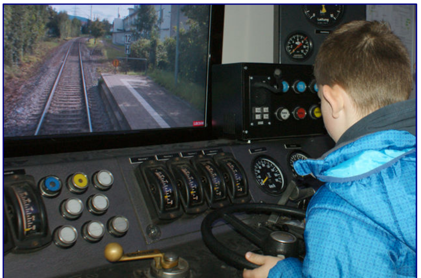
Früh übt sich, wer einmal ein guter Lokführer werden will: Punktgenaues Anfahren an den Bahnsteig gehört zu den Aufgaben im Führerstand der Baureihe 110 am Simulator.
