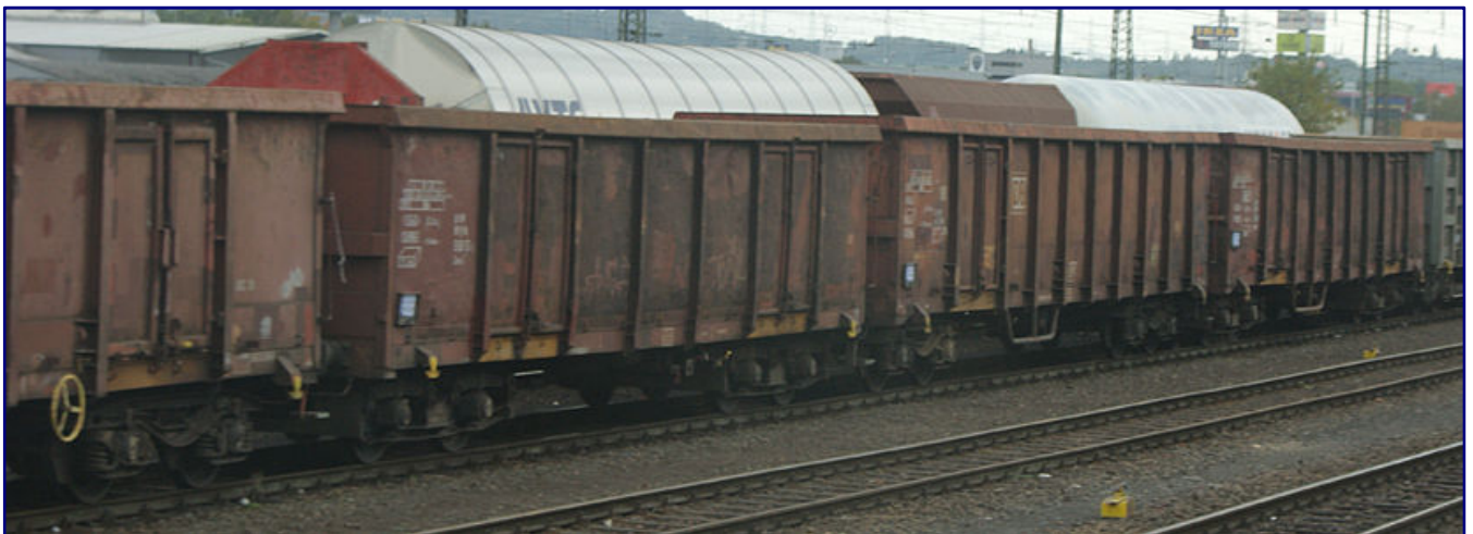
Vierachsige, offene Güterwagen der Regelbauart gehören heute zum gewohnten Bild in Güterzügen. Zu den beiden Wagen der Bauart Eanos-x (rechts im Bild) gesellt sich links daneben noch ein Vorgänger Eaos.
