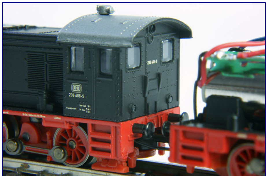
Der ungestörte Blick auf die Rückseite zeigt die (für 236 406-5 eigentlich nicht korrekte) Position des oberen Spitzenlichts und die sehr flache Darstellung des Übergangsgeländers. Rechts und links der Kupplung befinden sich die Kabeldurchführungen zur anderen Lokhälfte.
