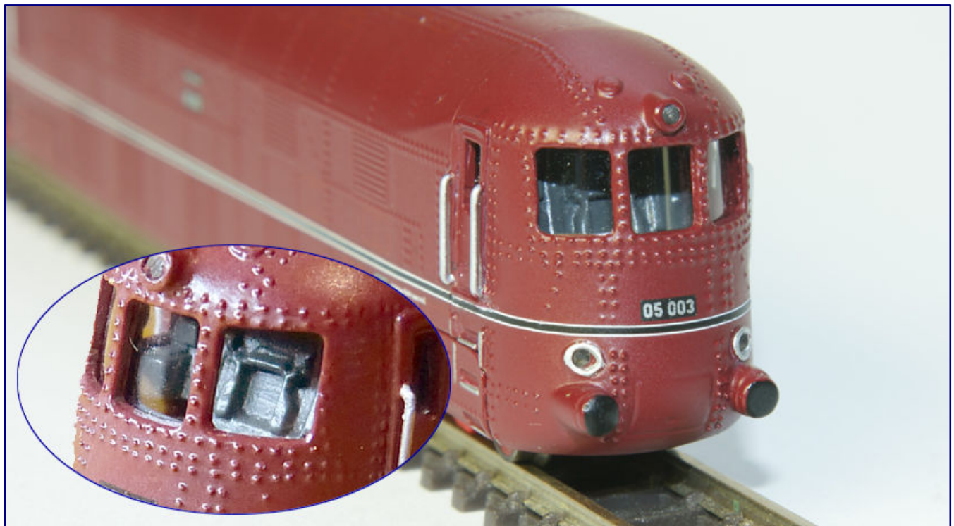
Die Führerstandseinrichtung wird nur bei gezielter Ausleuchtung von außen sichtbar. Zweifel bleiben, ob die Öffnung zur Feuerbüchse wirklich der Bauart Marcotty entsprach (zu sehen im Außenfenster des Bildausschnitts). Vergessen wurde auf jeden Fall das Handrad der Steuerung, das im Hauptbild auf der Lokführerseite ins Stirnfenster ragen müsste. Bildausschnitt: Jörg Erkel
