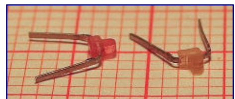
Durch den Einsatz einfacher LED lassen sich alte Märklin-Lichtsignale wiederverwenden. Fotos: Peter Grundmann
