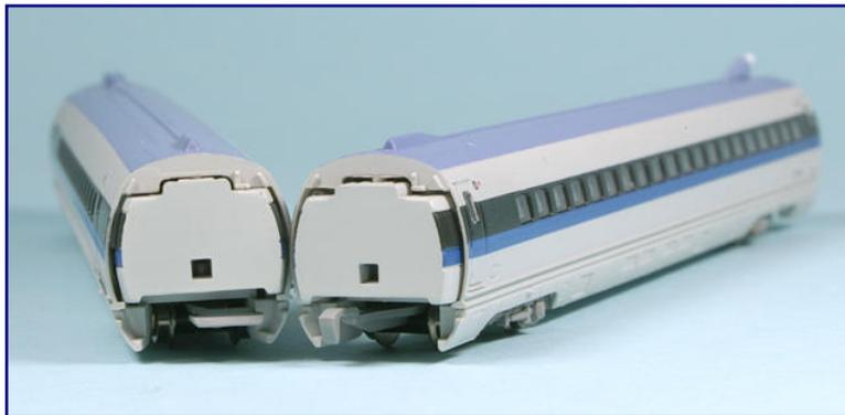
In den federnd gelagerten Übergangsnachbildungen ist keine elektrische Verbindung versteckt. Der Fahrstrom wird also in beiden Richtungen vom angetriebenen Zwischenwagen aufgenommen. Dies ist auch bei der Länge der Halteabschnitte vor Signalen zu berücksichtigen.
