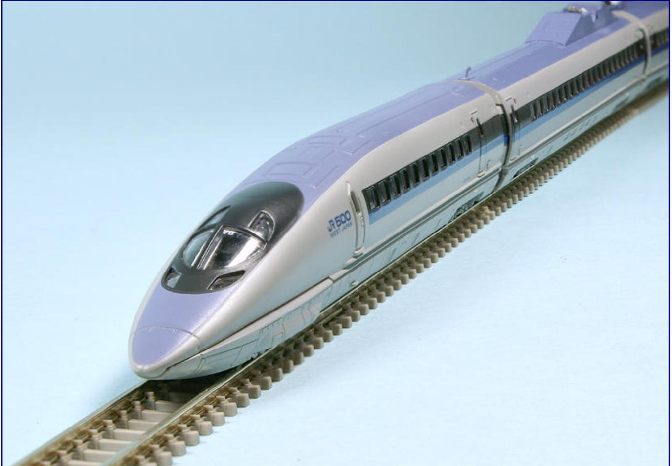
Bereits 0,3 Volt Gleichspannung reichen dem schnittigen Renner zum Anfahren. Mit Schrittgeschwindigkeit setzte sich das Rokuhan-Modell in Bewegung und hat dennoch keine Probleme die umgerechnete Höchstgeschwindigkeit des Vorbilds zu erreichen.
