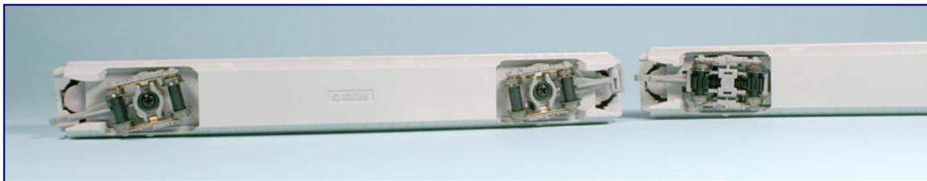
An allen Achsen des Zuges wird Strom an der Spitzenlagerung abgenommen, was angesichts des Leichtlaufs wohl kaum vermutet wird: Davon profitiert die Innenbeleuchtung der nicht angetriebenen Mittelwagen (links), aber auch der Motor am Antriebswagen (rechts). Leider liegen bei ihm die Zahnräder offen, was Verschmutzungen anzieht.
