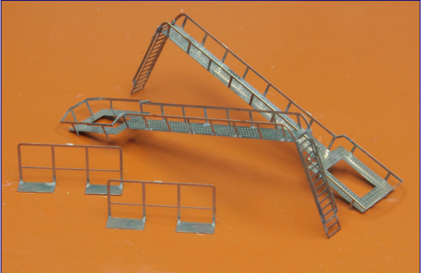
Als Folge der Bauschritte 1 bis 6 stehen aus dem Bausatz nun alle erforderlichen Teile für die Umrüstung von zwei Kesselwagen fertig bereit. Foto: Andreas Petkelis
