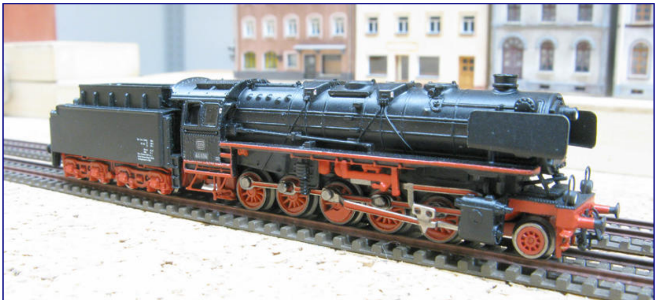
Zu den auffälligsten Änderungen am Modell gehören neben der Pufferbohle die Nachbildung des Innenzylinders, das größere Gegengewicht an der Treibachse und die freistehenden Leitungen unter dem Führerhaus.
