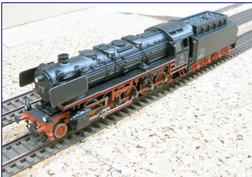
Die Erfolge von Dirk Rohwerders Umbau zeigen sich besonders im Bereich der Lokfront. Endlich zeigt auch das Modell den fürs Vorbild typischen Abschluss der Windleitbleche mit der Pufferbohle.
