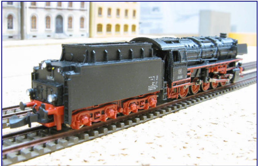
Auch der Tender erlebte einige Umbauten, von denen nicht alle äußerlich zu sehen sind. So wird er künftig auch für die Stromabnahme herangezogen und erhöht auf diese Weise die Fahrsicherheit.
