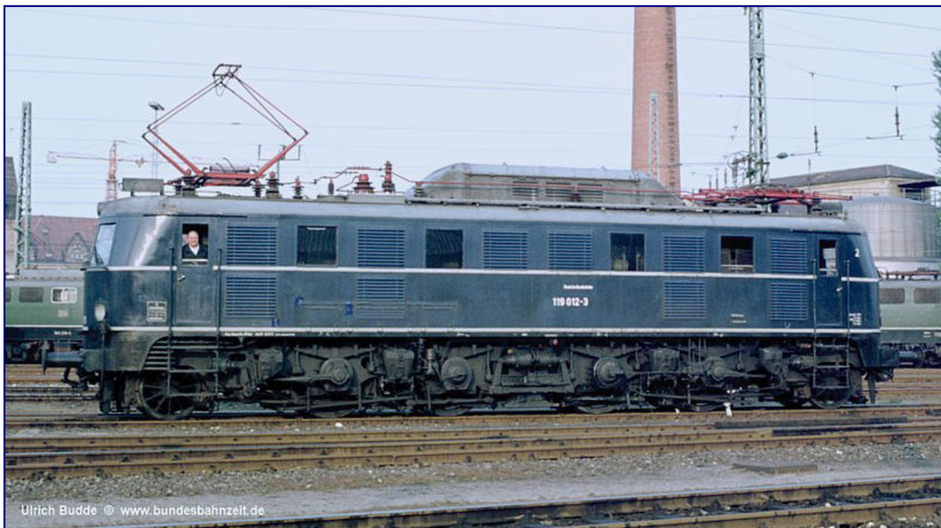
119 012-3 zeigt sich am 25. September 1976 dem Fotografen. Sie trägt zwei Neubaustromabnehmer der Bauart DBS 54, die sie erst drei Jahre zuvor erhalten hat. Gut zu sehen ist auf diesem Bild das außen liegende Bremsgestänge der beiden Henschel-SSW-Maschinen. Foto: Ulrich Budde
