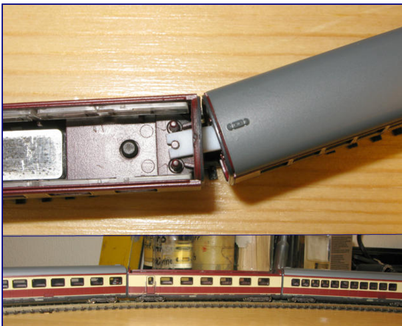
Gewusst wie: Die Zwischenwagen des VT 11 5 sind mittels selbst gefertigter Klauenkupplungen kurzgekuppelt. Foto: Dirk Rohwerder
