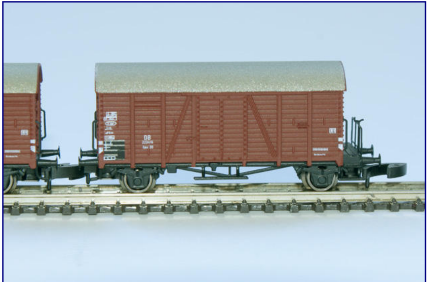
Typisches Merkmal eines Oppeln sind das spitz zulaufende Sprengwerk und der geräumige Aufbau in Bretterwandstruktur. Bei der Version mit Bühne ist allerdings das Fahrwerk länger, weshalb bei gleichem Achsstand die Lage der Achshalter verändert ist.
