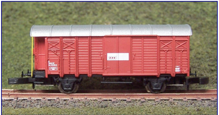
Eine interessante Variante des Schweizer Güterwagens K3 ist diese Ausführung mit Bremserhaus und Federpuffern der Bodensee-Toggenburg-Bahn. Foto: FR Freudenreich Feinwerktechnik
