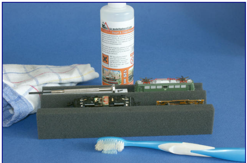
Eine Lokliege hält beim Zerlegen und Zusammenbau das Werkstück in Position. Darüber hinaus half uns das Exemplar von Volker Wienke mit Magnetauflage, alle Einzelteile geordnet abzulegen.
