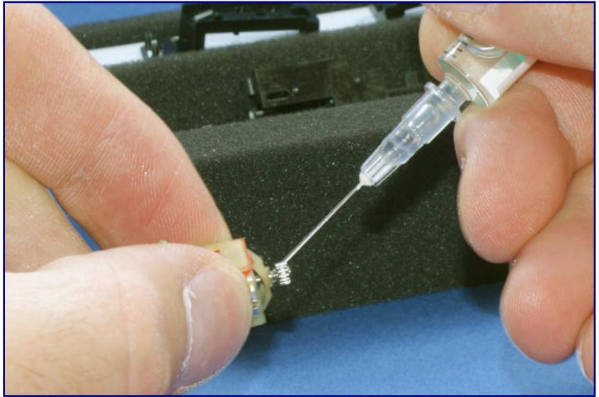
Auch die Lager der Motorwelle verlangen nach ausreichender Schmierung. Erreichbar sind sie am besten mit der Nadelspitze.
