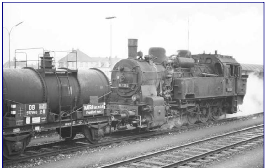
Zur den Ursprungsmerkmalen der preußischen T 16 1 gehörte auch der Rauchkammerzentralverschluss. Bei der DB behielten ihn nur wenige Maschinen wie hier die 94 1254. Foto: Walter Patzke, Sammlung Petkelis
