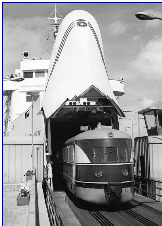
Die Fährverbindung nach Warnemünde wurde nach dem 2. Weltkrieg von der DR aufrecht erhalten. Drei ineinander verschlungene Gleise führten ins Innere der Fähre. Foto: Scandlines, Photoarchiv Eschenburg
