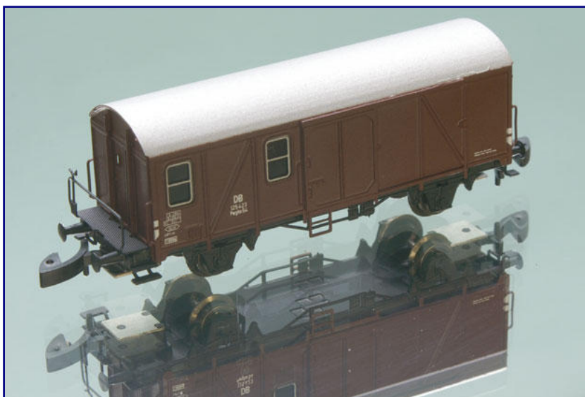
2013 soll die Bauform B des Pwghs 54 erscheinen, die auf dieser Fahrzeugseite durch ein weiteres Fenster zwischen den beiden sichtbaren gekennzeichnet ist. Deren wenige Vorbilder wurde Mitte der sechziger Jahre vermutlich für Leig-Einheiten konzipiert.
