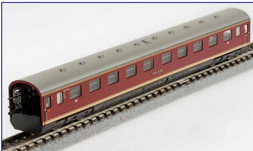
Der zweite Mittelwagen VM 08 520 mit der Wagennummer 162 ist mit dem ersten bis auf die Anschriften identisch. Unverändert vom Vorgängermodell wurde die elektrische Kupplung unter Verzicht auf nachgebildete Wagenübergänge übernommen. Foto: Peter Fingerhut
