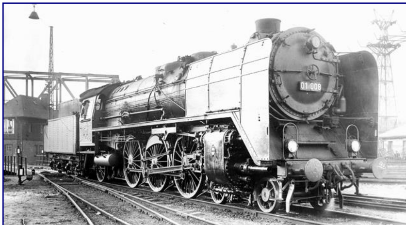
01 008 wurde mit der Fabriknummer 12000 von Borsig gebaut und als erste Lok dieser Baureihe an die Deutsche Reichsbahn abgeliefert. 1932 besitzt sie eine elektrische Beleuchtung, große Wagner-Bleche und einen genieteten Tender 2'2' T32. Foto: DLA Darmstadt, Sammlung Eisenbahnstiftung
