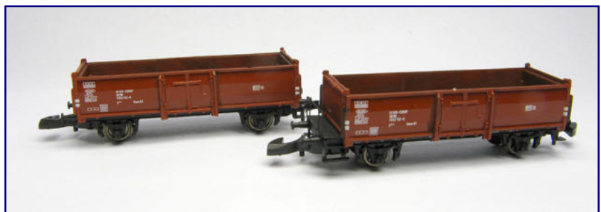
So sehen offene DB-Wagen der Bauart Omm 52 in exakt maßstäblicher Länge aus – mit oder ohne Bremserbühne. Foto: Dirk Rohwerder
