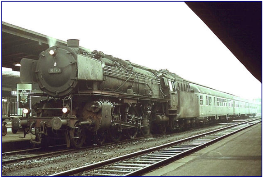
Das Aussehen der Baureihe 01 veränderte sich bei der DB durch das Entfernen der Frontschürzen. 01 170 hatte auch das mittlere Stück unter der Rauchkammer verloren. Am 11.2.1967, nur einen Monat vor ihrer Z-Stellung, wartet sie in Paderborn vor E 4620 Paderborn – Dortmund (- Duisburg) auf Ausfahrt. Foto: Helmut Dahlhaus
