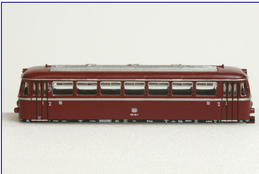
Das Gehäuse des Schienenbusses zeigt nun auch farblich abgesetzte Details wie Türfalten und Ausstellfenster. Noch fehlen die neuen Puffer, denn einige Montageschritte standen zum Zeitpunkt der Aufnahme noch aus.
