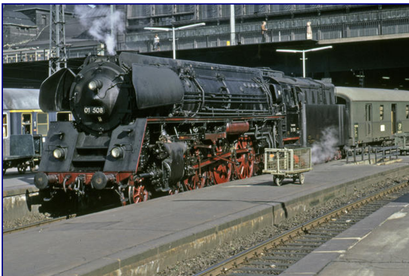
Reko-Lok 01 508 vom Bw Wittenberge besitzt neben Ölhauptfeuerung auch eine spitze Rauchkammertür ist zudem eines von nur acht Exemplaren mit Boxpok-Rädern. Am 2. Juli 1968 wartet sie in Hamburg Hbf vor D 163 nach Berlin auf die Abfahrt. Foto: Will A. Reed, Sammlung Eisenbahnstiftung
