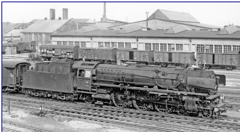
Deutlich moderner präsentiert sich die von der DB umgebaute 01 223 mit Neubaukessel, Witte-Windleitblechen und geschweißtem Einheitstender 2'2' T34. Sie ist außerdem eines von nur fünf Exemplaren mit Rollenlagern (August 1961). Foto: Carl Bellingrodt, Sammlung Eisenbahnstiftung
