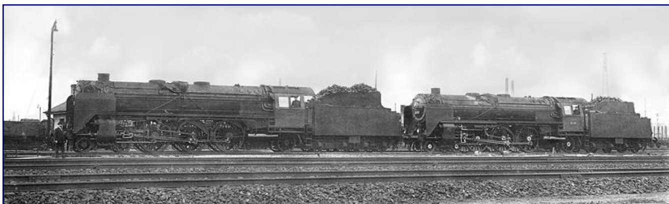
Die Vergleichsaufnahme zeigt die neuen 01 003 (links) und 02 005 (rechts), die im Aufnahmejahr 1926 im Betriebsdienst praktisch in denselben Dienstplänen erprobt werden, um die wirtschaftlichere der beiden Bauarten zu ermitteln. Foto: Werner Huber, Sammlung Eisenbahnstiftung.
