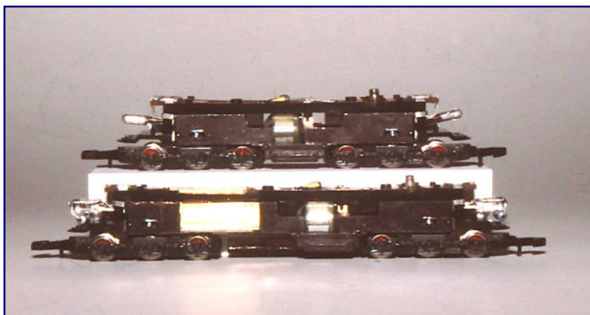
Das Fahrwerk der Baureihen 103 und 151 von Märklin (oben) diente als Basis. Mit Hilfe von Messing-Teilen wurde es auf die korrekte Länge gebracht. Ein Kompromiss ist der symmetrische Achsstand der Diesellok.
