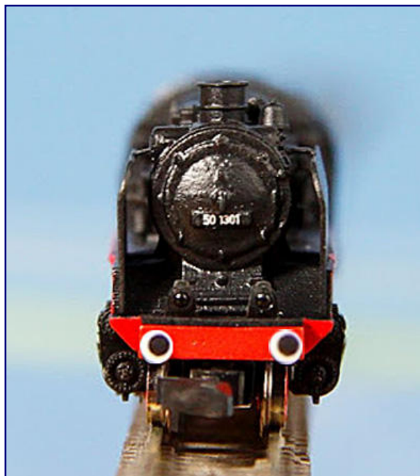
Ein Warnanstrich auf größenrichtigen Puffertellern gehört ebenfalls zu den Produktmerkmalen der BR 50 sowie der überarbeiteten 44.
