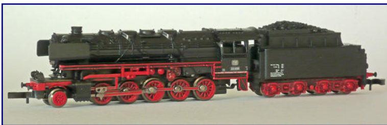
Sehr vorteilhaft wirkt sich nach dem Umbau der verkürzte Lok-Tender-Abstand aus. Foto: Jochen Brüggemann
