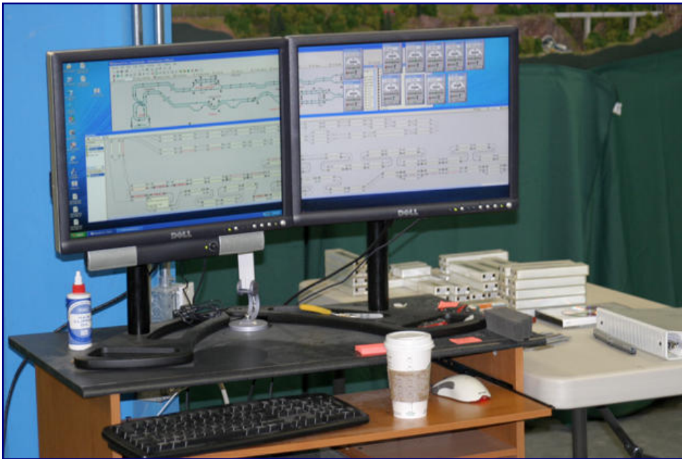
Gesteuert wird die Riesenanlage digital mit Digitrax-DCC. Ein Computerprogramm erlaubt die Bedienung und Überwachung mittels Computer über zwei Monitore.
