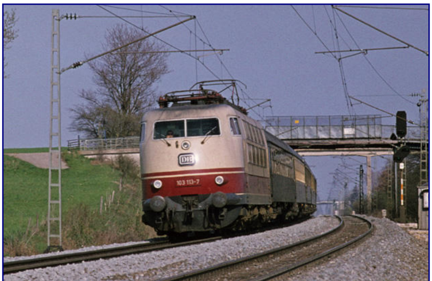
1970 beginnt die Serienauslieferung von zwei wichtigen Fahrzeugen: Die in acht Exemplaren beschaffte Baureihe 210 (Bild oben) ist die schnellste Diesellok der DB. Das neue Paradeferd ist ab sofort die Baureihe 103 (Bild unten), ausgerüstet zunächst mit Frontschürze und Scherenstromabnehmer des Typs DBS 54 mit Wanisch-Wippe. Fotos: Eckerle, Sammlung Petkelis
