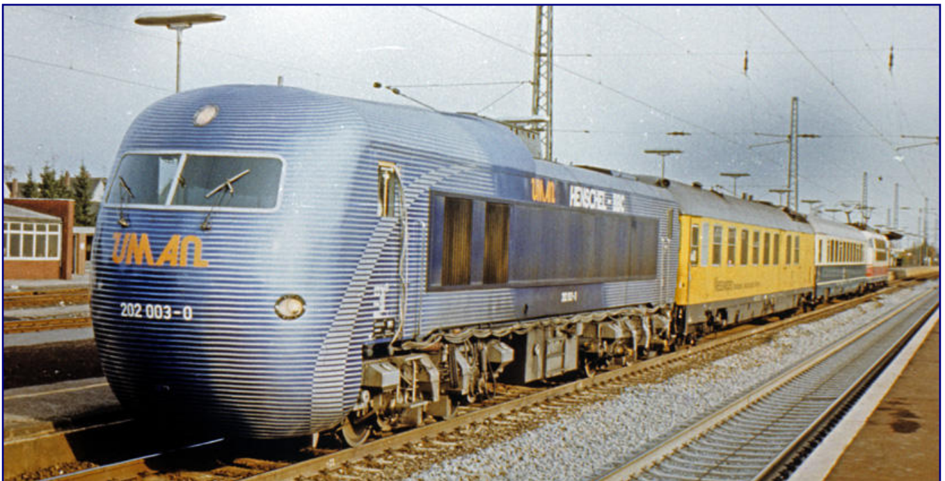
202 003-0 wird umgebaut und erhält eine Stirnverkleidung, die an die Form der Baureihe 103 angelegt ist. So ausgestattet führt die Bundesbahn ab 1982 Versuche mit der Umkopplung der Antriebsmassen („UmAn“) durch. Foto: Sammlung Petkelis
