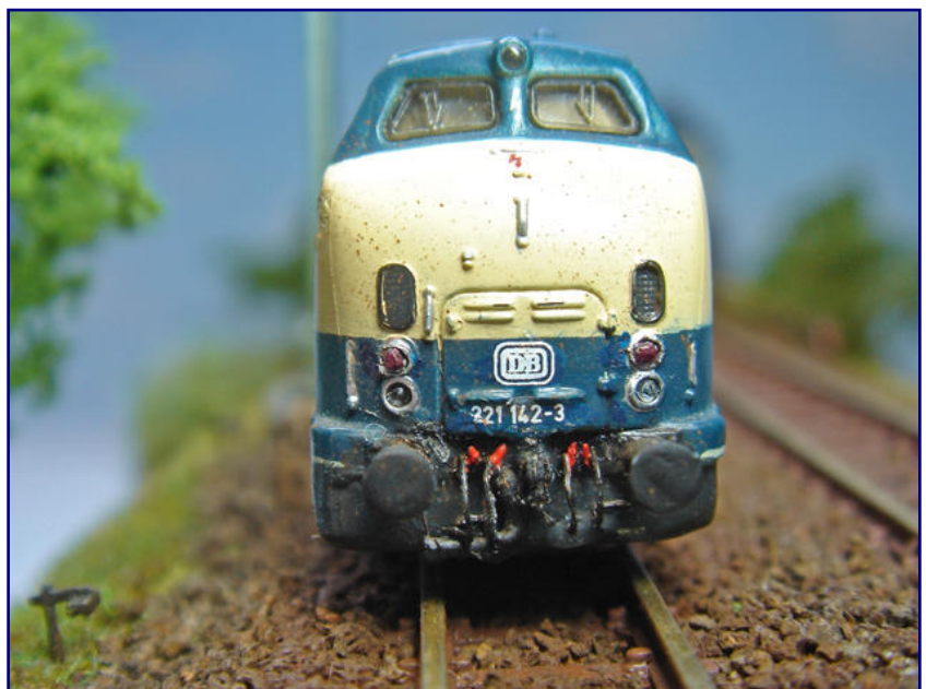
Fertig zugestrichelt und lackiert präsentiert sich die Pufferbohle, nachdem auch die Heizkupplung (am unteren Schürzenrand) mit Litzendraht nachgebildet wurde.
