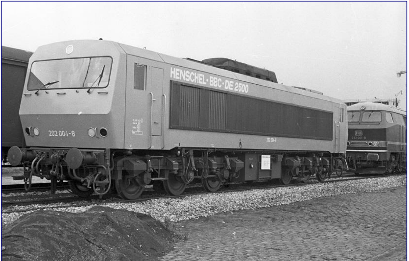
Die drei dieselelektrischen Lokomotiven der Baureihe 202 werden von der Bundesbahn erprobt, doch zeigt sie kein Interesse daran - dafür aber deren Drehstromtechnik. 202 004-8 erhält wegen ihrer Grundfarbe den Spitznamen „Blauer Bock“. Foto: Walter Patzke, Sammlung Petkelis
