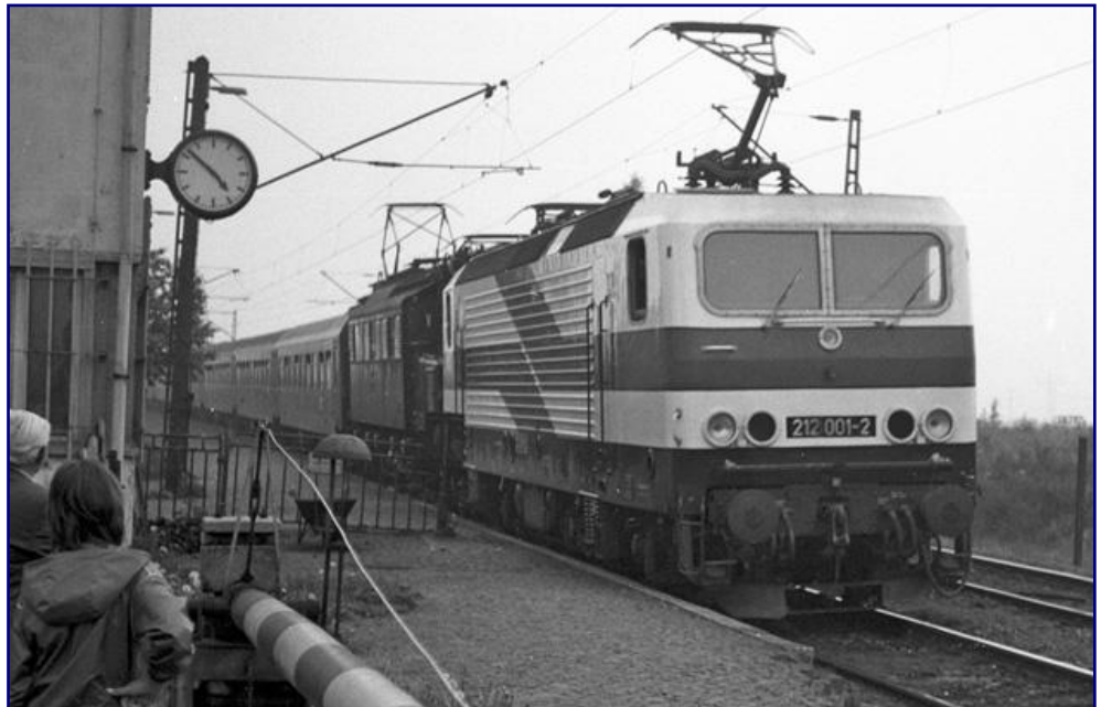
212 001-2 wird auf der Leipziger Frühjahrsmesse 1982 erstmals vorgestellt. Von den Serienlokomotiven unterscheidet sie sich durch die Maschinenraumfenster im Dachbereich sowie eine später noch leicht geänderte Stirnform. Attraktiv und für die DDR ungewöhnlich ist die Lackierung der „Weißen Lady“. Foto: Walter Patzke, Sammlung Petkelis
