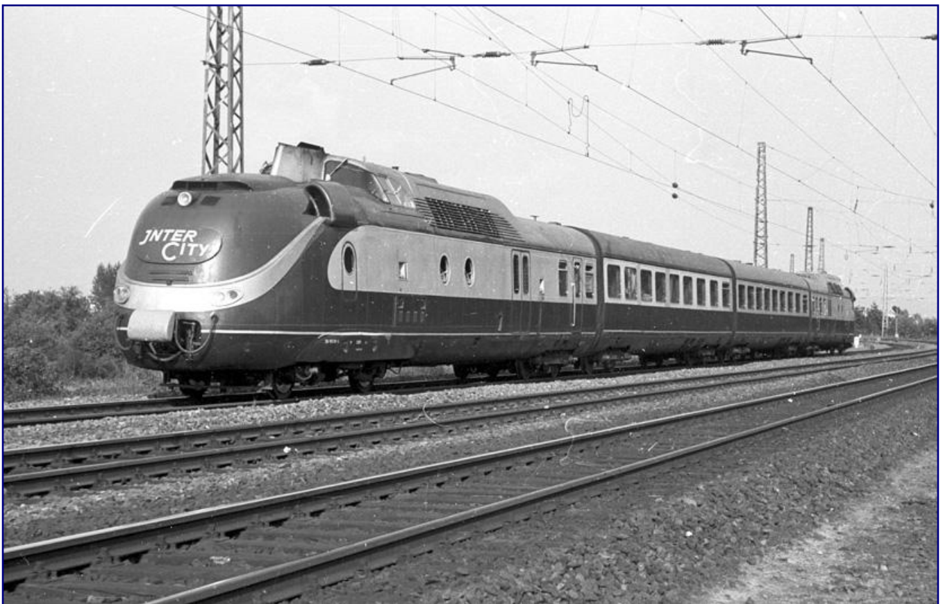
Eine Leistungssteigerung der Baureihe 601 wird 1970 durch Ausrüstung mit Gasturbinen erreicht: Eine vierteilige Einheit der neuen Baureihe 602 erreicht auf einer Messfahrt zwischen Hannover und Celle im April 1976 eine Rekordgeschwindigkeit von 217 km/h. Foto: Walter Patzke, Sammlung Petkelis
