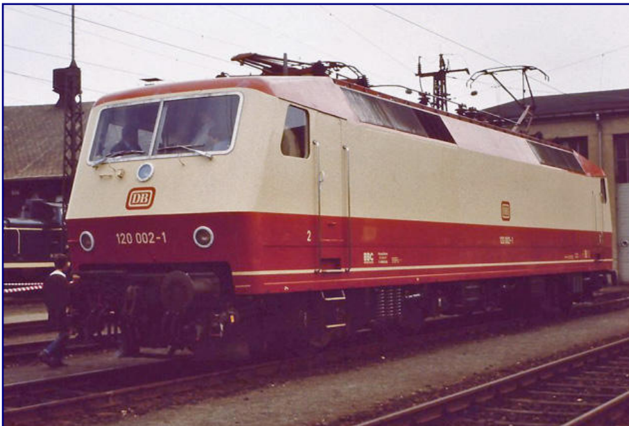
Mit 120 002-1 stellt die Bundesbahn auf der Internationalen Verkehrsausstellung 1979 in Hamburg die weltweit erste Drehstromlok vor. Foto: Benedikt Dohmen, Archiv-Nr. 63/28
