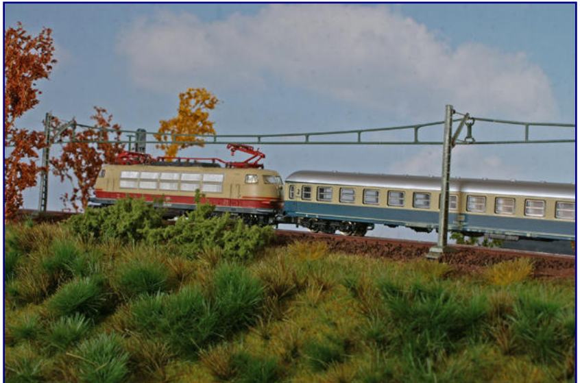
Unter dem Motto „Jede Stunde – jede Klasse“ geht der zweiklassige IC am 27. Mai 1979 an den Start. Dafür werden Personenzugwagen Bm 234 lauftechnisch für 200 km/h ertüchtigt und als Bm 235 bezeichnet.
