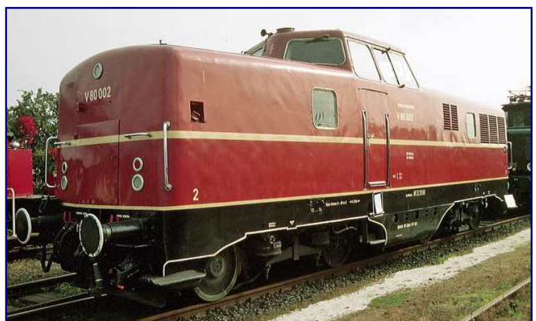
Neuland betrat die Bundesbahn 1952 mit ihrer ersten Gelenkwellenlok, der V 80. Sie lieferte wertvolle Erfahrungen für den Bau der V 200 und V 100.
