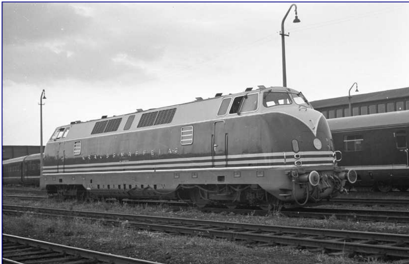
Nach einem Umbau mit Leistungssteigerung auf 3.000 PS übernimmt die Bundesbahn die hier im Bild gezeigte ML 3000 C' C' von Krauss-Maffei als Baureihe V 300. Foto: Walter Patzke, Sammlung Petkelis
