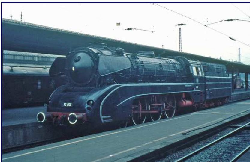
Die beiden Maschinen der Baureihe 10 sind 1957 die letzten an eine deutsche Staatsbahn neu ausgelieferten Schnellzugdampflokomotiven. Zum Zeitpunkt ihrer Indienststellung sind sie bereits vom Strukturwandel überholt worden. Foto: Olaf Wrede, Sammlung Holger Späing
