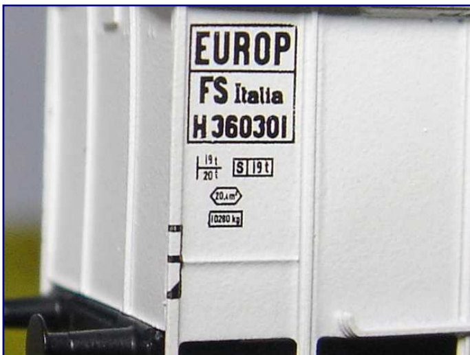
Die richtige Wagenausstattung zu bestimmen, war keine leichte Aufgabe für FR, doch sie wurde gut gelöst: Die Gewichts- und Kapazitätsangaben auf der Wagenwand stimmen. Auch das Bremszeichen entspricht exakt der Vorbildausstattung.
