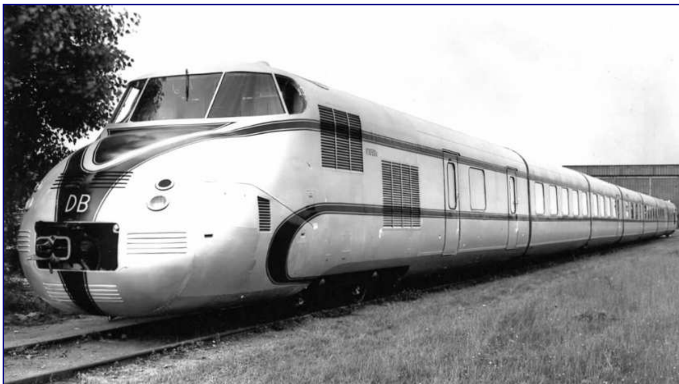
Der VT 10 501 in der Ursprungsausführung, wie er 1953 auf der Deutschen Verkehrsausstellung in München gezeigt wurde: Der Scheibenwischer des Führerstands wird von oben geführt, die dunkle Lackierung des unteren Wagenkastenbereichs reicht noch über das Triebdrehgestell bis zur im Bogen endenden, unteren Zierlinie. Foto: LHB, Sammlung Dr. Rolf Löttgers
