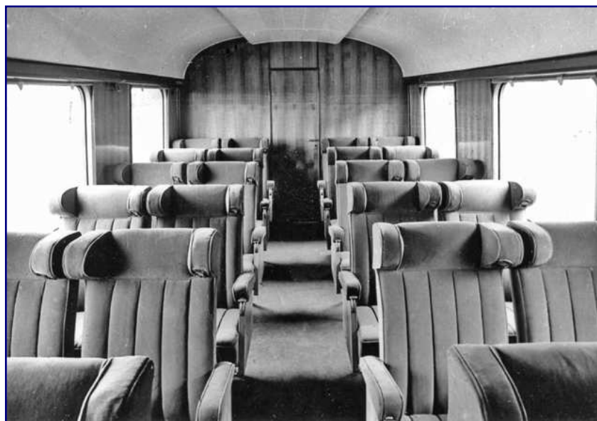
Seinen Fahrgästen bot der „Senator“ bequeme und verstellbare Polstersitze, die Wände wirkten durch Holzvertäfelungen elegant und gediegen. Erstmals erhielt mit dem VT 10 5 ein deutscher Zug eine Vollklimatisierung nach dem System Stone. Foto: LHB, Sammlung Dr. Rolf Löttgers
