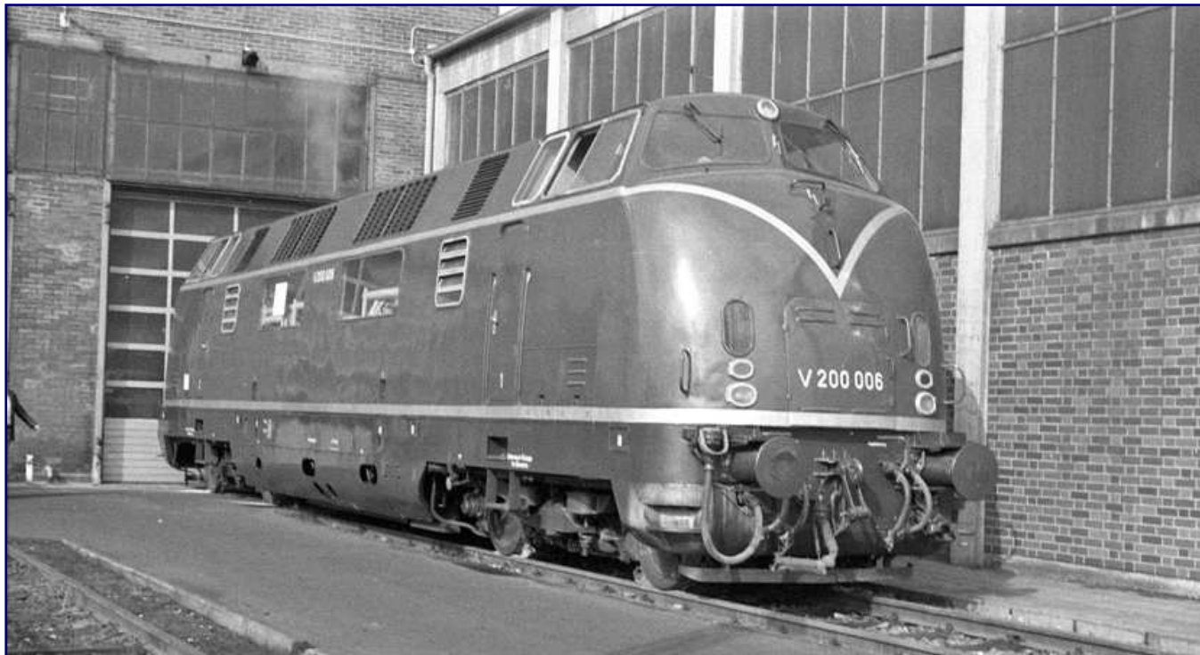
Ab 1956 werden die Serienlokomotiven der Baureihe V 2000 an die Bundesbahn ausgeliefert. Sie werden zu einem Symbol des deutschen Wirtschaftswunders. Die erste Serienlok V 200 006 trägt auf dieser Aufnahme noch keine Eigentumsanschriften der Bahnverwaltung. Foto: Walter Patzke, Sammlung Petkelis
