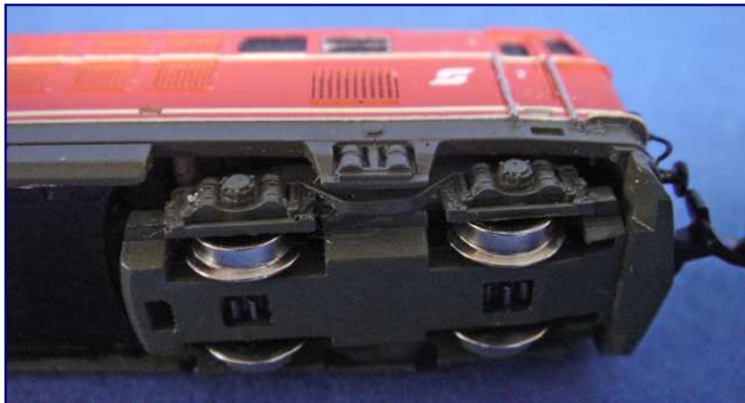
Die Gravur der Drehgestellblenden zeigt viele, feine Details. Zu ihnen gehören auch die mit ausschwenkenden Schienenräumer. Eine Märklin-Kupplung sorgt für volle Großserienkompatibilität.
