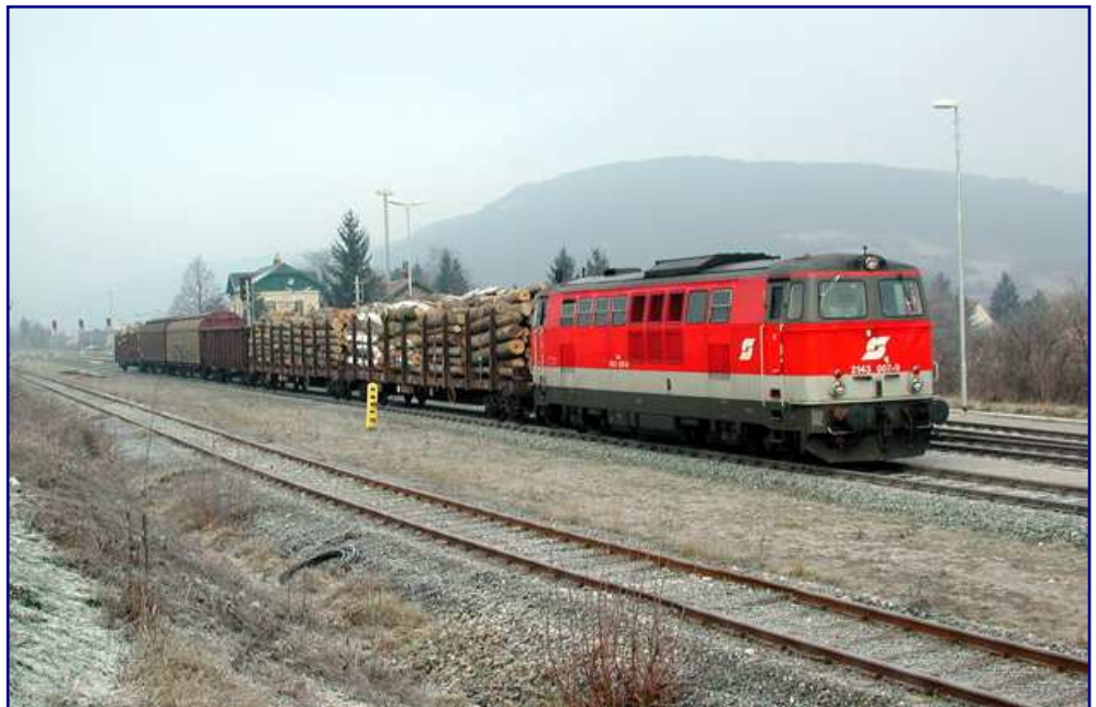
2143 007-9 gehört zur ersten Serie ohne Vielfachsteuerung. Als sie am 16.1.2001 mit einem Güterzug im Bahnhof Wöllersdorf (Niederösterreich) fotografiert wird, trägt sie die sogenannte Valousek-Lackierung. Foto: Herbert Ortner
