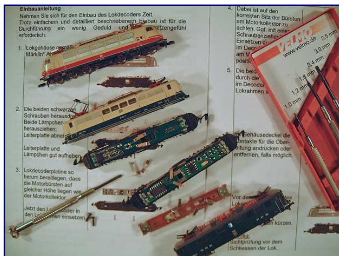
Die Decoder LD26220 und LS26220-A werden ab sofort mit Haltespangen für die Befestigung der Bürsten ausgestattet. Foto: Velmo, Claudius Veit
