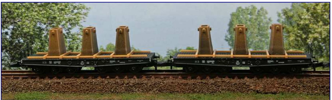
Das Schwerlastwagen-Pärchen SSym 46 mit Guskokillen als Ladegut (Art.-Nr. 82356) gehört zu den aktuellen Märklin-Neuheitenauslieferungen. Die Wagen tragen Anschriften der Epoche III.
