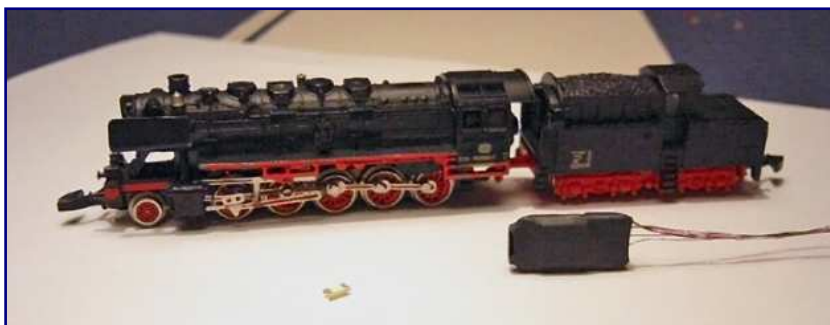
Ausgangspunkt für den Umbau: eine Schlepptenderdampflok von Märklin (Art.-Nr. 8884), eine SMD-LED für den Umbau der Beleuchtung und der Märklin-Motorola-Dekoder. Foto: Roland Lohsträter
