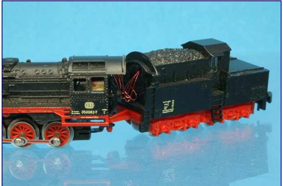
Die Drähte vom Dekoder zum Motor wurden durch ein Loch im oberen Bereich der Tendervorderwand geführt.
