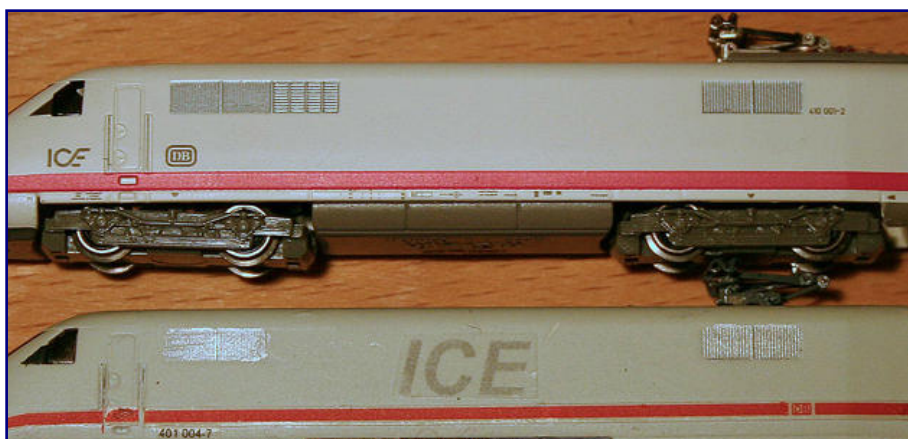
Auch an den Triebköpfen bleibt viel zu tun: Als Erstes werden die überzähligen Lüftungsgitter verspachtelt. Foto: Torsten Scheithauer
