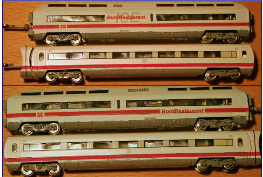
Der meiste Aufwand entsteht beim Umbau zum charakteristischen Buckelspeisewagen: Der Vergleich beider Fahrzeugseiten zum Ursprungsmodell verdeutlicht die erforderlichen Änderungen an der Küchenseite (oben) und Gangseite (unten). Foto: Torsten Scheithauer
