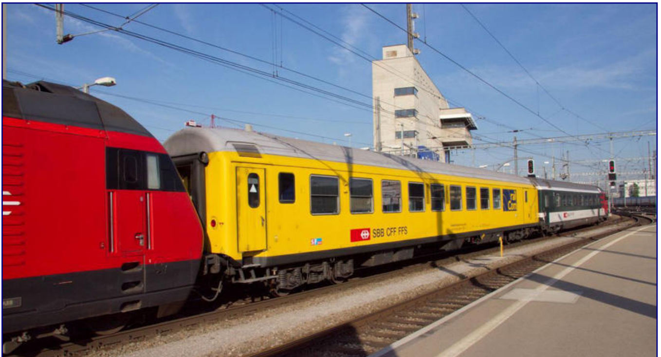
Dieser Messzug aus Re 460, dem Funkmesswagen und einem EW-IV-Steuerwagen Bt war die Vorbildvorlage für Jens Wimmels Umbau. Der Zug ist hier in Zürich unterwegs. Foto: Adrian Senn
