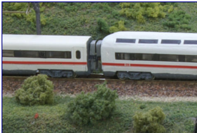
Der Umbau beginnt mit den Arbeiten an den Wagenübergängen. Betroffen sind nicht nur die Faltenbälge sondern auch der Wagenkörper selbst.
