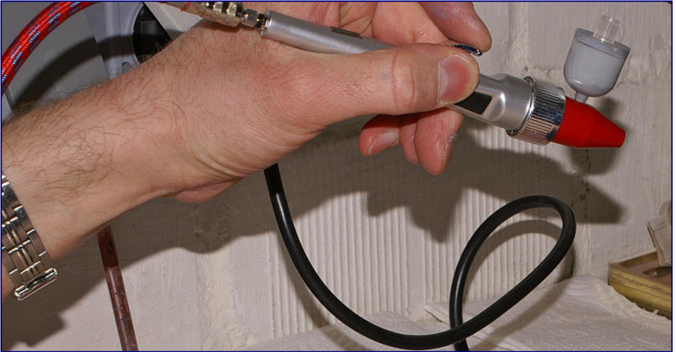
Das ergonomische Konzept der Herpa-Spritzpistole macht sie auch für Linkshänder geeignet. Die Gummieinlagen rechts und links des Farbhebels schützen sie wie auch die Rechtshänder vor einem Abrutschen der bedienenden Hand.
