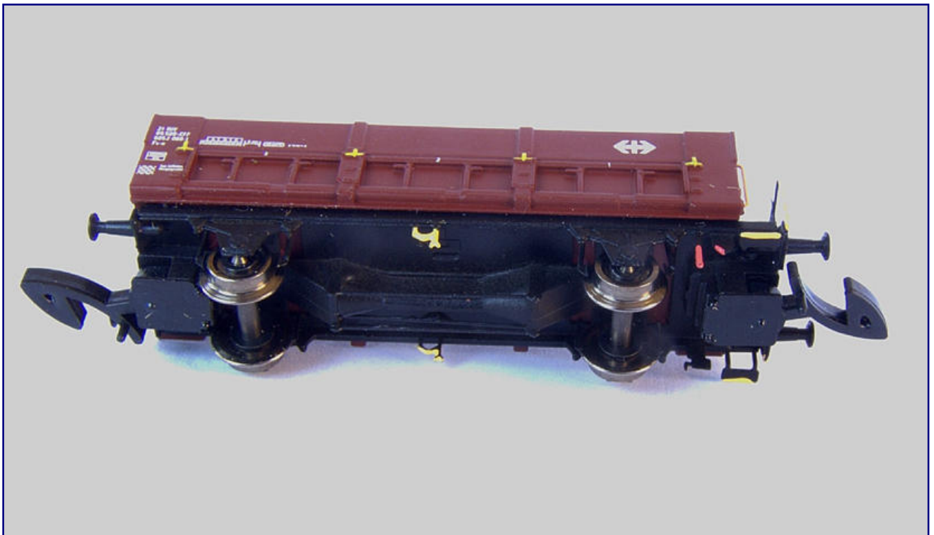
Dieser Wagentyp entsteht in Mischbauweise: Der aus Kunststoff gespritzte Aufbau ruht auf einem Fahrwerk aus verlöteten Ätzbauteilen. Angenehm fallen auch die Details wie Bremsstellhebel und Fischbauchträger am Wagenboden auf.
