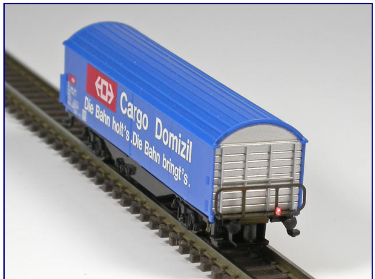
Neu sind die mit 83 Hz Frequenz blinkenden Schlussleuchten nach SBB-Vorbild im Angebot von High Tech Modellbahnen. Foto: Achim Grob
