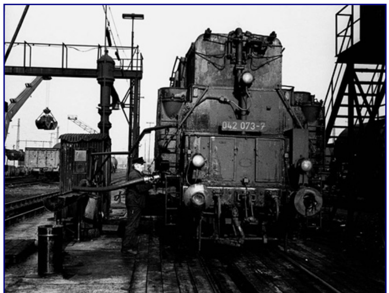
Herr Pausewang betankt im Bw Rheine die 042 073-7 über das Steigrohr – eine Besonderheit nur der Betriebswerke Emden und Rheine. Foto: Wolfgang Staiger
