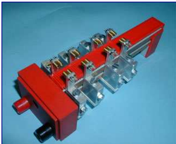
Selbstgebauter Rollenprüfstand aus dem Leserkreis. Foto: Ralf Lentzen
