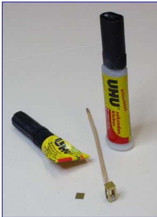
Zum Verbinden der Teile kommt Sekundenkleber zum Einsatz. Dosiert wird der Auftrag durch die Spitze eines Zahnstochers. Schwierig ist das Einsetzen des Türgriffs.
