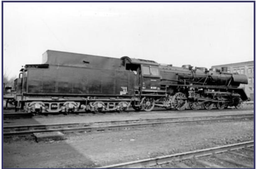
Diese Aufnahme zeigt 41 309 aus dem Bestand der DB. Sie besaß bis zuletzt einen dreidomigen Kessel, hat aber hier schon Windleitbleche der Bauart Witte erhalten. Außergewöhnlich ist der Tender 2'2' T32, mit dem die Serienlokomotiven nicht ausgeliefert wurden. Die Lok wurde am 24.2.1967 ausgemustert.
