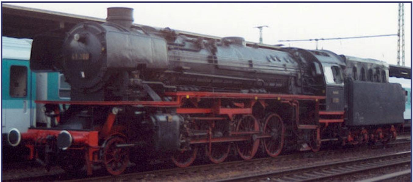
41 360 (ex 042 360-8) erhielt bei der DB einen Neubaukessel und wurde anschließend auf Ölfuehrung umgebaut. So gehörte sie 1977 zu den letzten Maschinen im Bestand der Bundesbahn beim Bw Rheine. Bis heute ist die Lok, die auf den Namen „Lady of Bismarck“ getauft wurde, beim Verein Dampflok-Tradition Oberhausen betriebsfähig erhalten (Aufnahme: Dortmund Hbf, Juli 1995).
