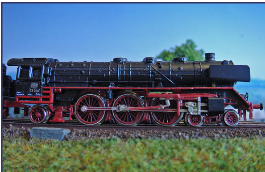
Gut zu erkennen ist der Indusi-Magnet auf der Lokführerseite, der am Nachlaufgestell befestigt ist. Für die zugehörige Elektrik mussten die Führerhausschilder weiter nach vorn versetzt werden.
