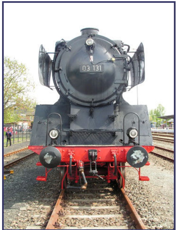
Vorn zeigt sich der Unterschied zur 01 durch den geringeren Kesseldurchmesser – 03 131 wirkt zierlicher. Foto: Deutsches Dampflokomotiv-Museum Neuenmarkt
