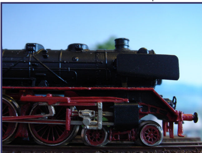
Seitenansicht des Laternenbügels, der Detailsteuerung, Rangierertritte und Vorlaufdrehgestell an 03 220.
