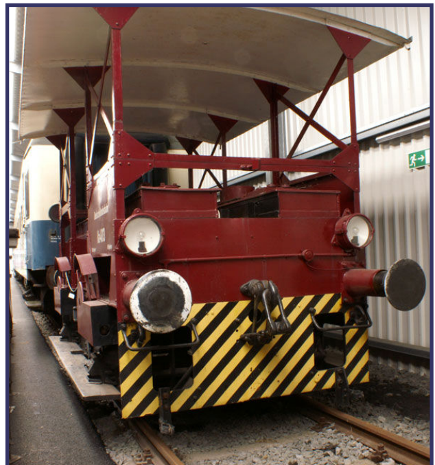
Auch so können Kleinlokomotiven aussehen: Es handelt sich hier um die elektrisch betriebene Akkulok Ka 4013 der DB, aufgenommen im DGE-Eisenbahnmuseum Bochum-Dahlhausen am 28. April 2006.
