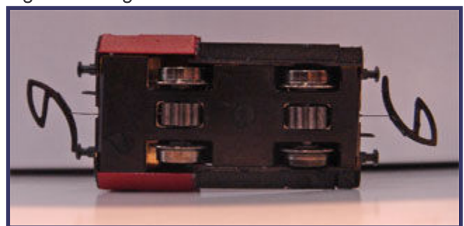
Ansicht von unten: Sichtbar für den interessierten Z-Bahner sind nur die großen Zahnräder. Über das Innenleben schweigt sich der Hersteller Z-Modellbau aus.
