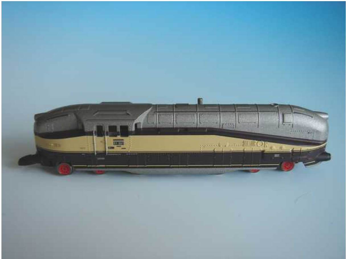
Gesamtansicht der Zuglok 61 001: Die an der ersten und letzten Laufachse ausgeschnittene Schürze ist kleineren Radien geschuldet, die ein Großserienmodell anstandslos befahren können muss.
