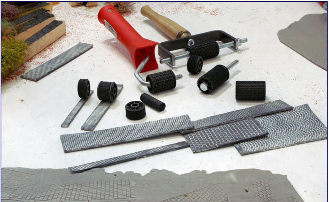
Unter den verschiedenen Prägewalzen für Straßenpflaster finden sich auch welche für die Spurweite Z. Das ausgerollte sowie auch gehärtete und nachkolorierte Materialveranschaulichen die Arbeitsweise der Microrama-Neuheit.
