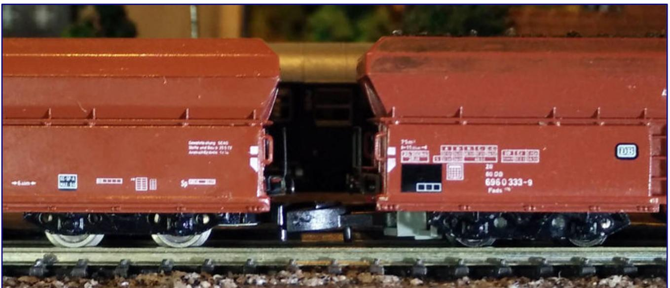
Nach dem Anpassen der Blenden ist der Waggon (links) kaum noch als Geisterwagen zu erkennen. Nur der hellgraue Kupplungsschacht kann ihn verraten, wenn wir von den austauschbaren, blank vernickelten Radsätzen des linken Serienmodells mal absehen. Foto: Thomas Heß
