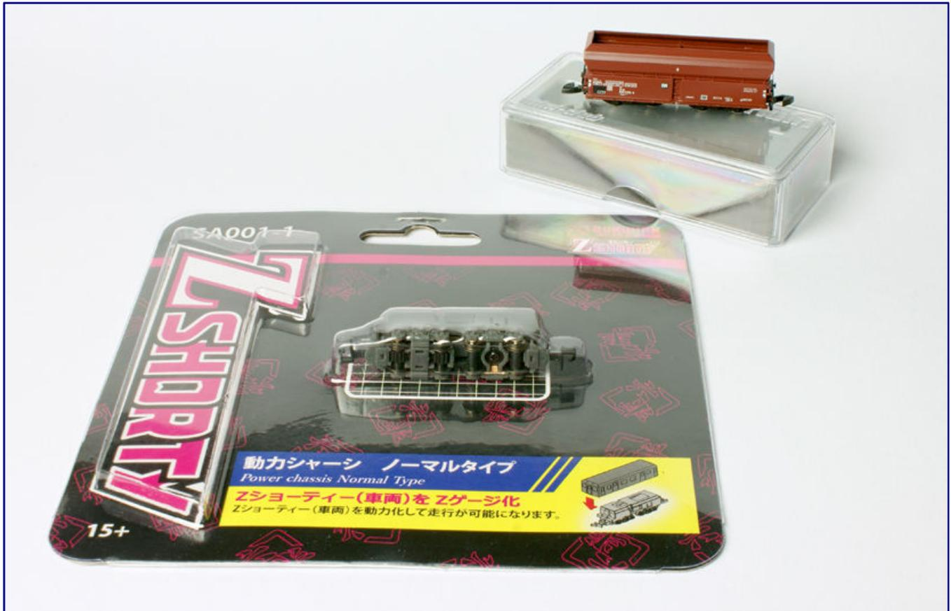
Ein motorisiertes Shorty-Fahrwerk von Rokuhan und ein gewöhnlicher Selbstentladewagen 8630 von Märklin genügen für den heute vorgestellten Umbau. Mittels eines D+H-Decoders wurde der Geisterwagen in diesem Fall sogar noch digitalisiert.
