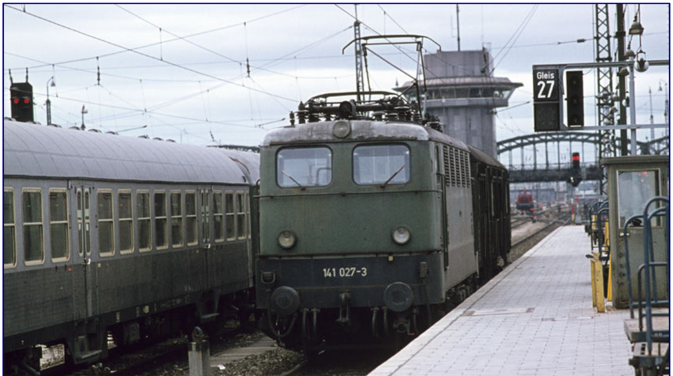
141 027-3 zeigt sich am 10. November 1974 beim Rangieren im Starnberger Flügelbahnhof (München Hbf) noch weitgehend im Ursprungszustand mit umlaufender Regenrinne, Trittrost und Haltestange sowie den ursprünglichen Lampen und Schweigerlüftern. Nur die Beschilderung wurde an das Computerzeitalter angepasst. Die Geräusche ihres Schaltwerks und die chromoxidgrüne Farbe brachten der Baureihe den Spitznamen „Knallfrosch“ ein. Foto: Eckerle, Archiv Petkelis
