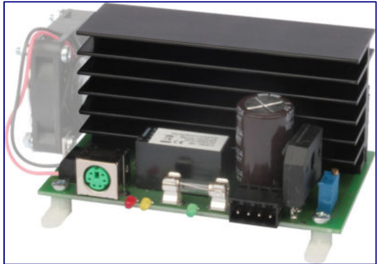
Blick auf das offene Leistungsteil des GFR1500 mit ansetzbarem Lüfter. Foto: Heißwolf Modellbahnzubehör
