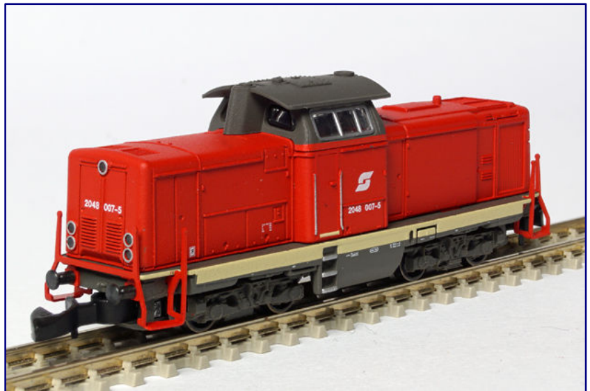
Mit der österreichischen Rh 2048 (88218) wurde nun auch das Fahrwerk der V 100 auf den Glockenankermotor umgestellt.
