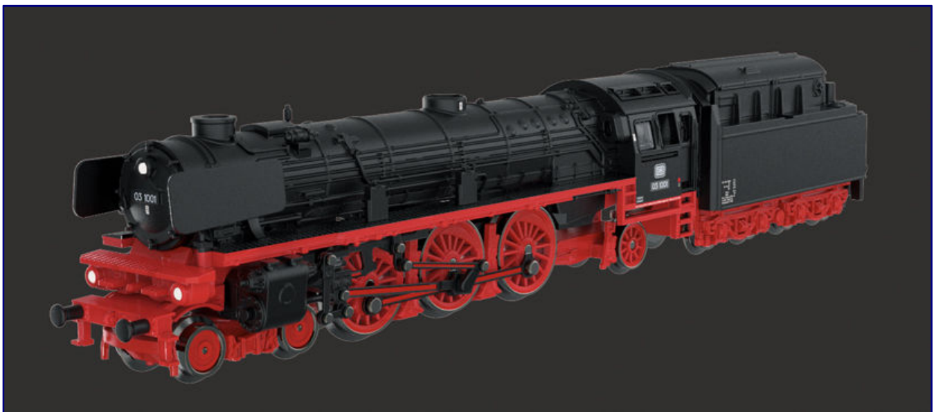
Die Schnellzugdampflok 03 1001 erscheint als Insider-Clubmodell 2019 mit Neubaukessel, hochliegenden Sandkästen und Kohlenkastenabdeckung am Tender (Art.-Nr. 88850). Damit entspricht sie dem Betriebszustand um 1958. CAD-Darstellung: Märklin
