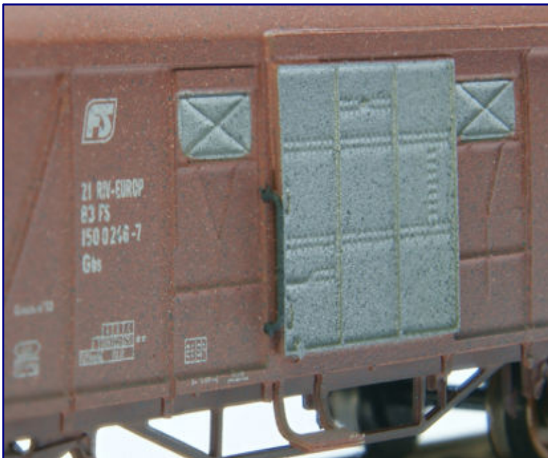
Die Leichtmetall-Schiebetür ist ein typisches Merkmal der italienischen Wagen und wurde auch im Modell korrekt wiedergegeben. Neben ihr befindet sich links eine separat angesetzte Griffstange. Die lupenlesbaren Anschriften wurden mittels Tampondruck aufgebracht und weisen dem Modell die Betriebsnummer 21 83 150 0 246 – 7 zu.
