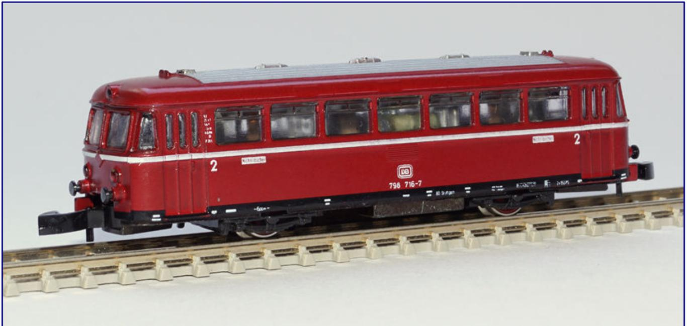
Das Ursprungsmodell wurde von einem Dreipolmotor mit Eisenkern angetrieben. Seine Schwäche waren Kontaktprobleme auf verschmutzten Schienen und im Weichenbereich. Ansonsten lässt sich damit, wie mit nahezu allen Modellen jener Zeit, eine durchaus gute Fahrkultur erreichen.
