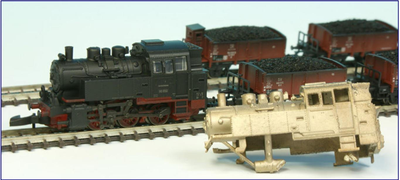
Neben der betriebsverschmutzten 80 032 liegt der Kohlenzug-Packung (Art.-Nr. 81352) unter dem Tiefzieheinsatz auch noch ein unlackiertes Ausschussgehäuse bei, das einen guten Eindruck vom genutzten Werkstoff Messing und dem Herstellverfahren vermittelt.
