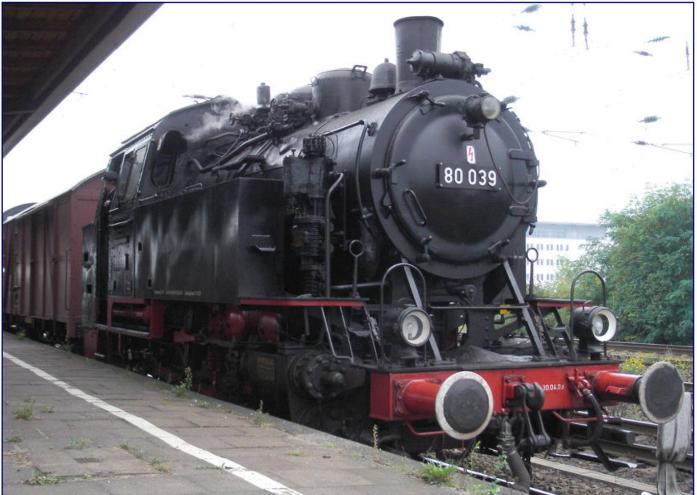
**Dritter Frühling:** Die bei der Hohenzollern AG in Düsseldorf unter der Fabriknummer 4650 gebaute 80 039 (vgl. Foto auf Seite 5) ist am 11. September 2005 im Bestand der Museumseisenbahn Hamm. Behalten hat sie bis heute ihre zweistufige Luftpumpe, später kamen noch geschweißte Wasserkästen und eine Kohlenkastenerhöhung aus Blech hinzu.
