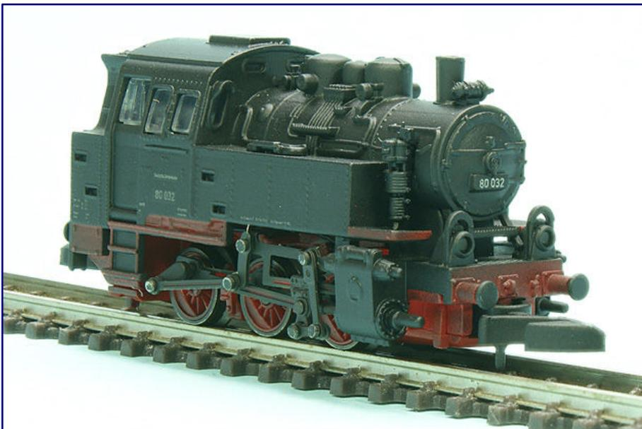
In der Schrägansicht werden viele der feinen Gravuren sichtbar, so etwa die Nieten auf dem Wasserkasten. Einige Teile, wie die zweistufige Luftpumpe oder der Turbogenerator vor dem Schlot sind separat angesetzt. Die Rauchkammertür trägt noch einen Zentralverschluss.
