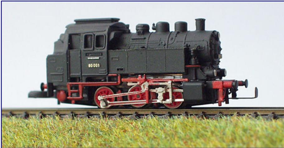
Auf Märklins Baureihe 89 basiert die Superung von Michael Bahls mit Detailsteuerung, Bremsnachbildungen, drittem Dom und genieteten Wasserkästen (Art.-Nr. 5080). Foto: Bahls Modelleisenbahnen
