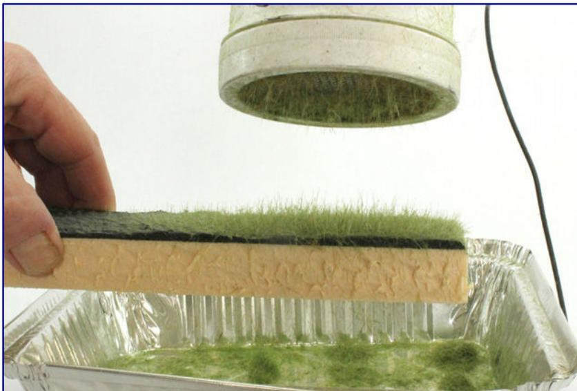
Den Unterschied zu anderen, elektrostatischen Techniken macht das ionisierende Kunstharz, hier als schwarze Schicht auf dem Teststreifen zu erkennen. Gefertigt werden daraus jetzt auch Bäume, die dadurch in gleicher Weise belaubt werden können. Foto: Microrama Model Decor
