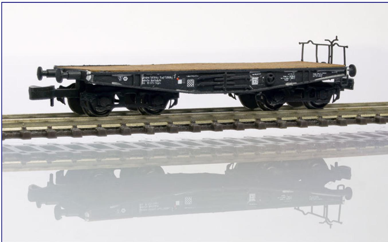
Geradezu filigran wirkt die Ursprungsausführung als SSKra der Deutschen Reichsbahn (ED0007; Bild oben) mit den im Bereich der Drehgestelle ausgesparten Fischbauchträgern. Die ebenfalls für die Epoche II beschriftete Variante mit Trapezträger (ED0001; Bild unten) stellt die endgültige Bauform dar, ist aber mit der zum Sechssachser gehörenden Bauartbezeichnung SSym beschriftet worden.
