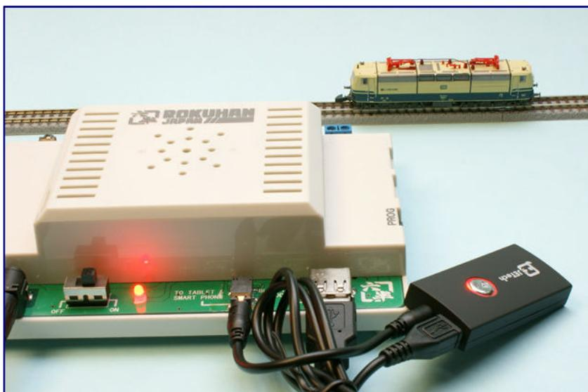
Statt kabelgebunden kann das Steuergerät auch über eine Bluetooth-Funkverbindung angesprochen werden. Der erforderliche Adapter gehört aber nicht zum Lieferumfang.
