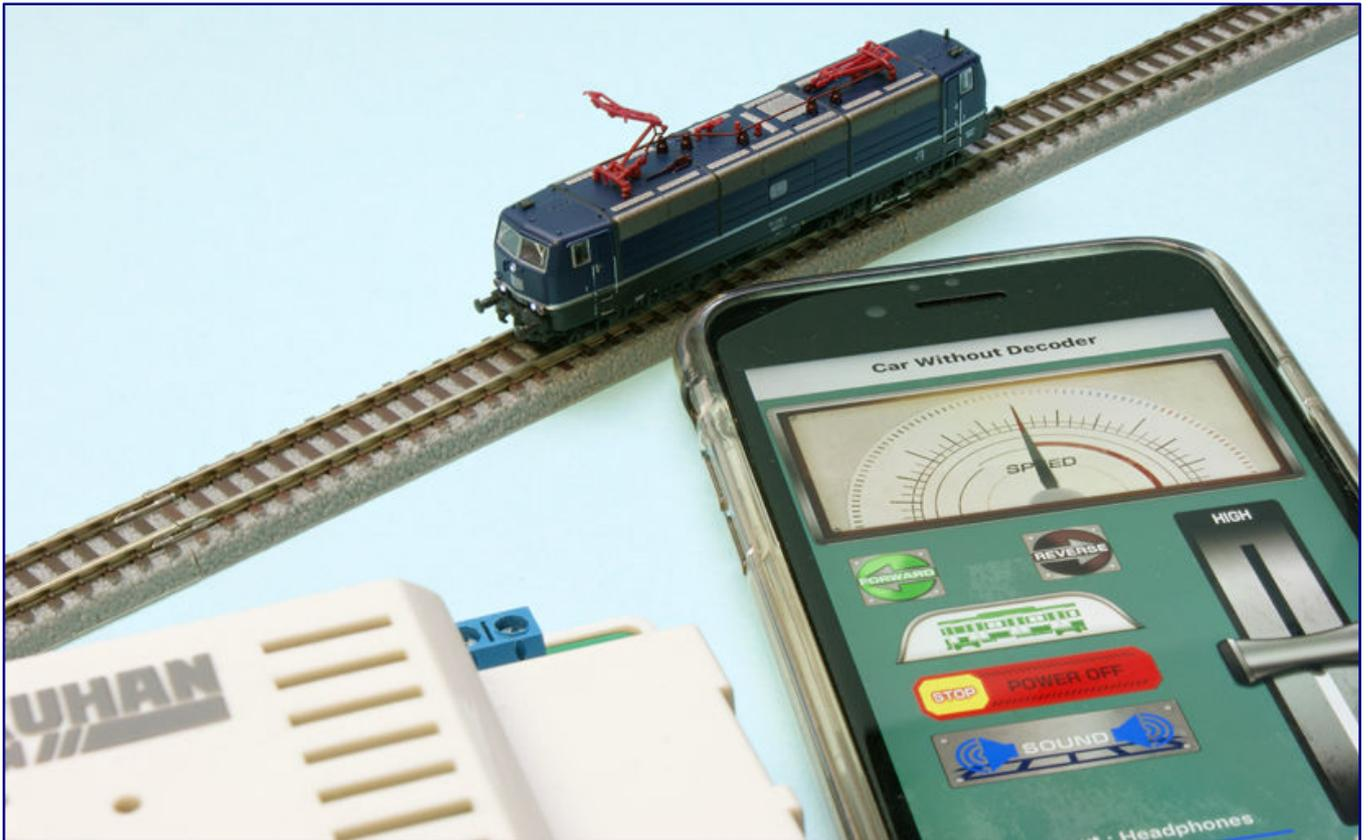
Im Analog-Fahrmodus steuern wir über den Schieberegler auf dem Berührungsbildschirm und lesen die eingestellte Geschwindigkeit über ein simuliertes Zeigerinstrument ab.
