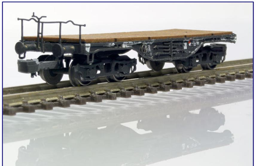
Ansprechend gestaltet sind bei den damit ausgestatteten Wagen die Bühnengeländer samt Handbremskurbel. Die Puffer haben flache und gewölbte Teller.
