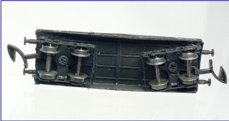
Der im Betrieb nicht sichtbare Wagenboden ist nur spärlich detailliert. Die Drehgestelle sind am Drehzapfen verschraubt.
