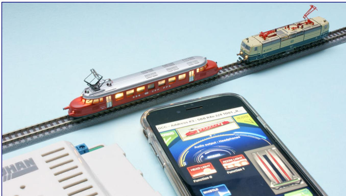
Ein großer Vorteil digitaler Steuerungen ist, dass mehrere Lokomotiven ohne elektrische Trennung unabhängig voneinander auf demselben Gleis fahren können. Zudem können wir verschiedene Funktionen schalten (im Bild Spitzenlicht und Innenbeleuchtung).
