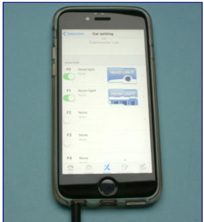
Wegen der Adressüberschneidung zum Roten Pfeil erhält 181 211-4 „Lorraine“ eine neue Adresse. Im Menü „Read/Write CV“ wählen wir die Adresse 81 (Bild links) und lassen sie ins CV-Register schreiben. Anschließend können wir dem Eintrag für diese Lok noch (Licht-)Funktionen zuweisen (Bild rechts).
